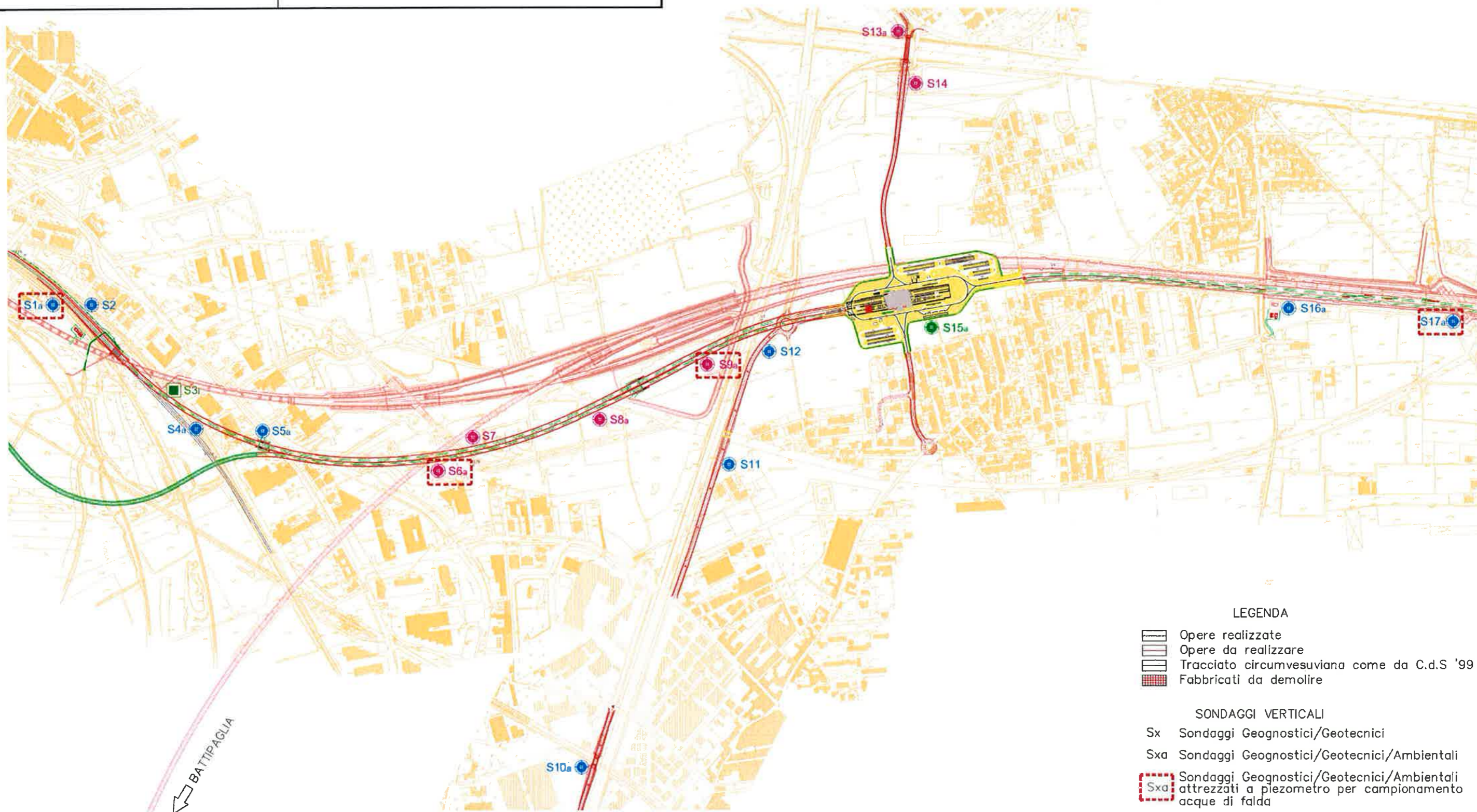
Figura 4.1 – Planimetria dei sondaggi geognostici di riferimento per le prove geofisiche (ved. tabella indagini svolte).
