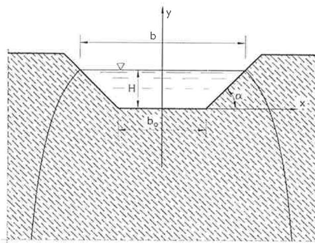
Figura 7 - Schema del funzionamento disperdente del fosso drenante.
