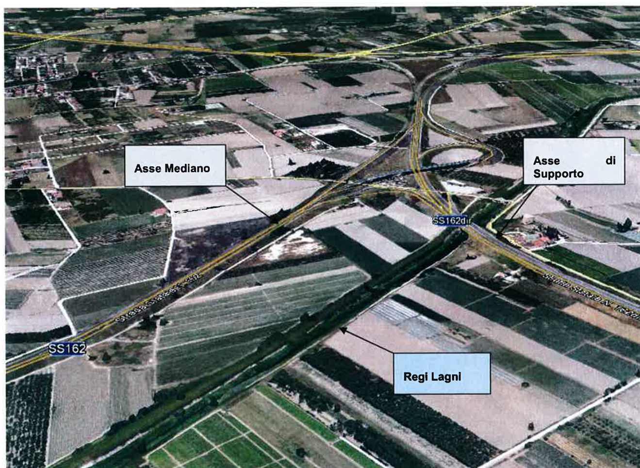
Figura 4-3 – Asse mediano e di Supporto che in questo ambito si scambiano con un svincolo a più livelli (Fonte: Google earth)
