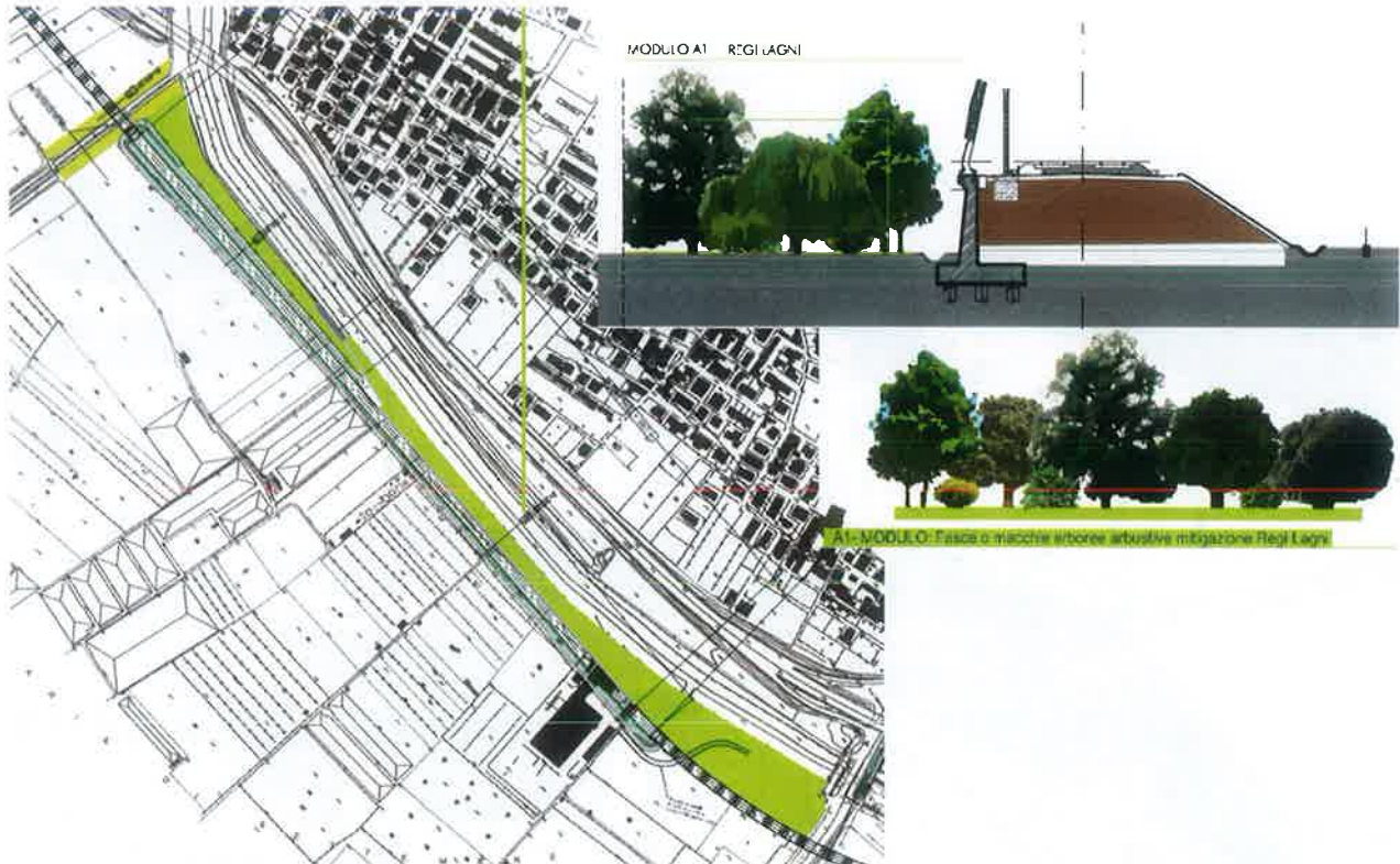
Figura 6-10 - Interventi di mitigazione in corrispondenza del canale dei Regi Lagni
