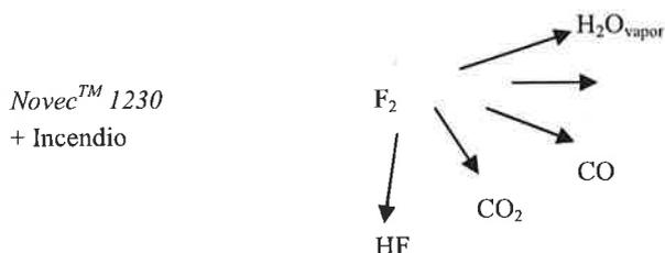
Figura 2: Decomposizione termica del Fluido Novec<sup>TM</sup> 1230 nella zona della reazione
