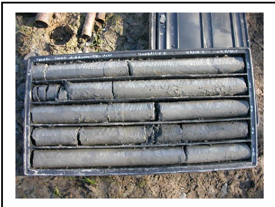
Foto 2: Sondaggio S1 - cassa 2 - da 5.00 m a 10.00 m.
