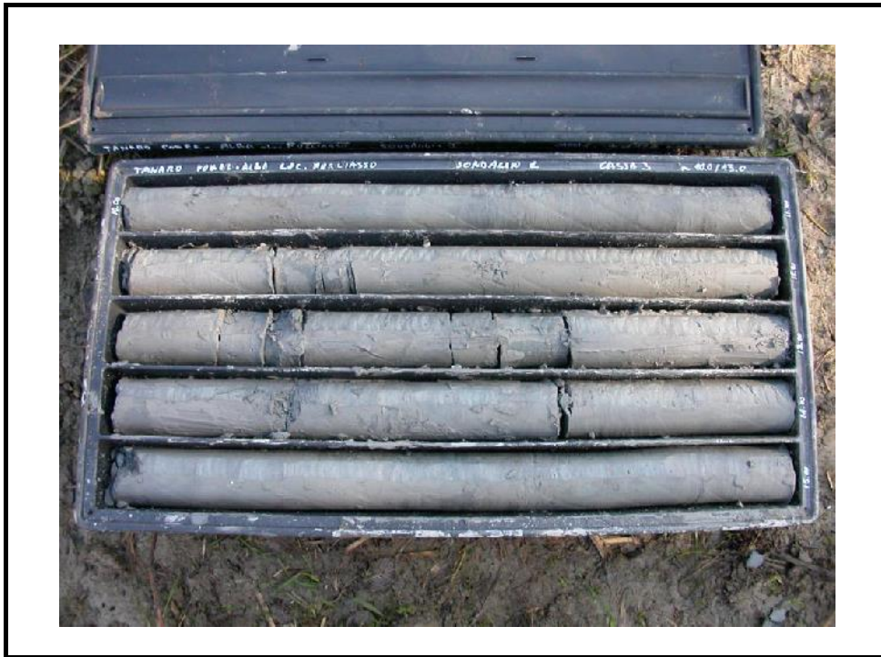
Foto 3: Sondaggio S1 - cassa 3 - da 10.00 m a 15.00 m.
