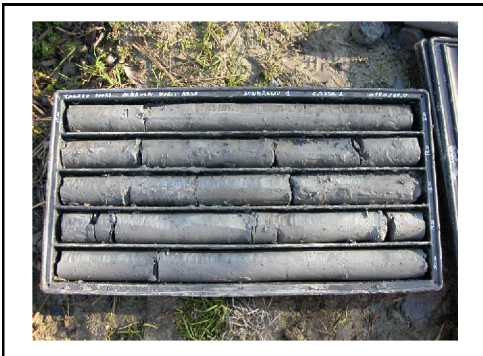
Foto 4: Sondaggio S1 - cassa 4 - da 15.00 m a 20.00 m.
