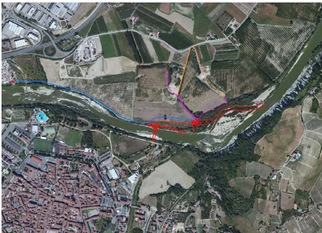
Fig. 2.1: planimetria opere in progetto su foto aerea. In rosso sono indicate le opere costituenti l'impianto in progetto, in blu l'elettrodotto interrato, in magenta le piste di accesso in progetto mentre in arancione quelle esistenti. Le linee in magenta e arancione tratteggiate individuano le piste di accesso alternative da utilizzare/realizzare nel caso in cui al momento della realizzazione della centrale sia presente il terzo ponte.
