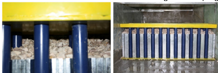
F31. Prove su modello fisico – Modello fisico banchina a giorno con combi-wall finestrati
