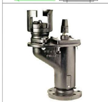
Idrante sottosuolo in ghisa, attacco a baionetta UNI 70, pressione di esercizio 10 bar, scarico automatico di svuotamento antigelo, cappello di manovra unificato manovrabile con chiave, anelli di tenuta e perno in ottone, flangia di base UNI EN 1092-1. Diametro Nominale 80 mm
