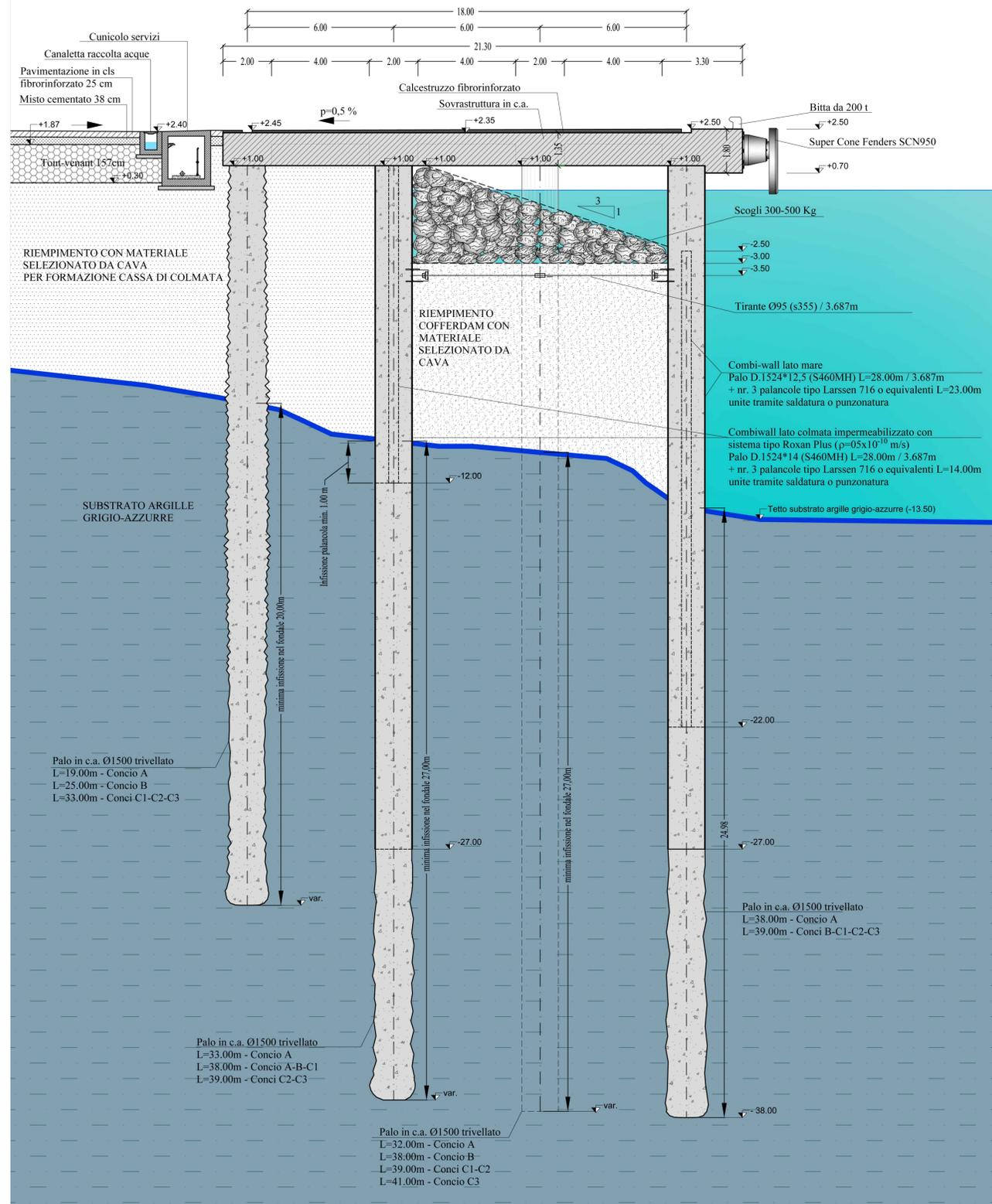
BANCHINA OPERATIVA SUD - SEZIONE TIPO 1 SULLA PALANCOLA - DA PROG. 0,00 m A PROG. 88,30 m - CONFIGURAZIONE FINALE - SCALA 1:100
