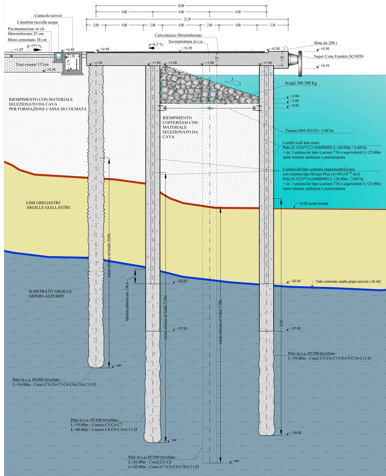
BANCHINA OPERATIVA SUD - SEZIONE TIPO 3 SULLA PALANCOLA - DA PROG. 135,40 m A PROG. 298,60 m - CONFIGURAZIONE FINALE - SCALA 1:100
