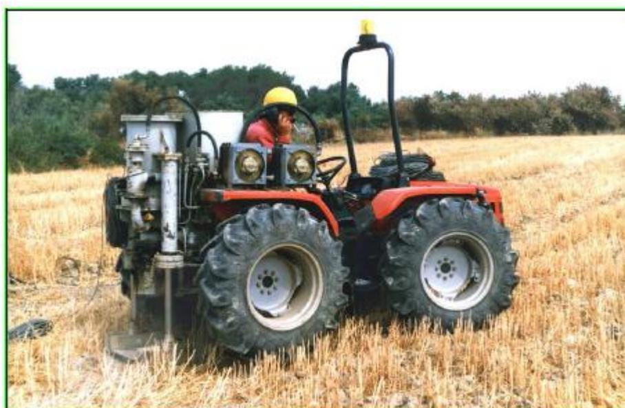
*Figura n. 13: Vibroseis leggero montato su mezzo agricolo operativo in area appenninica*
