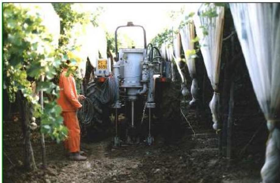
Figura n. 14: Acquisizione mediante sorgente a vibrazione
