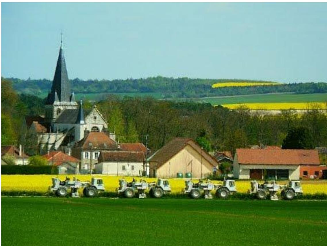
Figura n. 28: Esempio di utilizzo di Vibroseis in prossimità di beni architettonici
