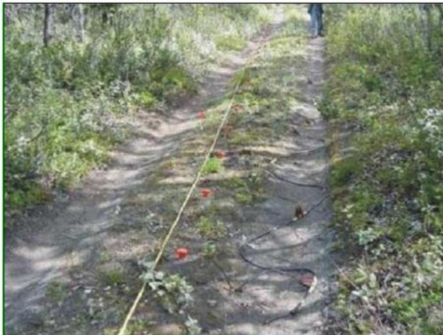
Figura n. 24: Esempio di stendimento geofoni su strada sterrata
