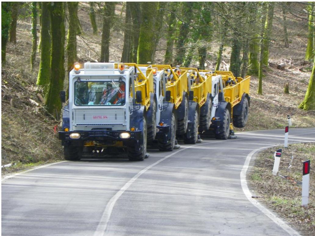
Figura n. 27: Esempio di vibratore predisposto per l'energizzazione del terreno
