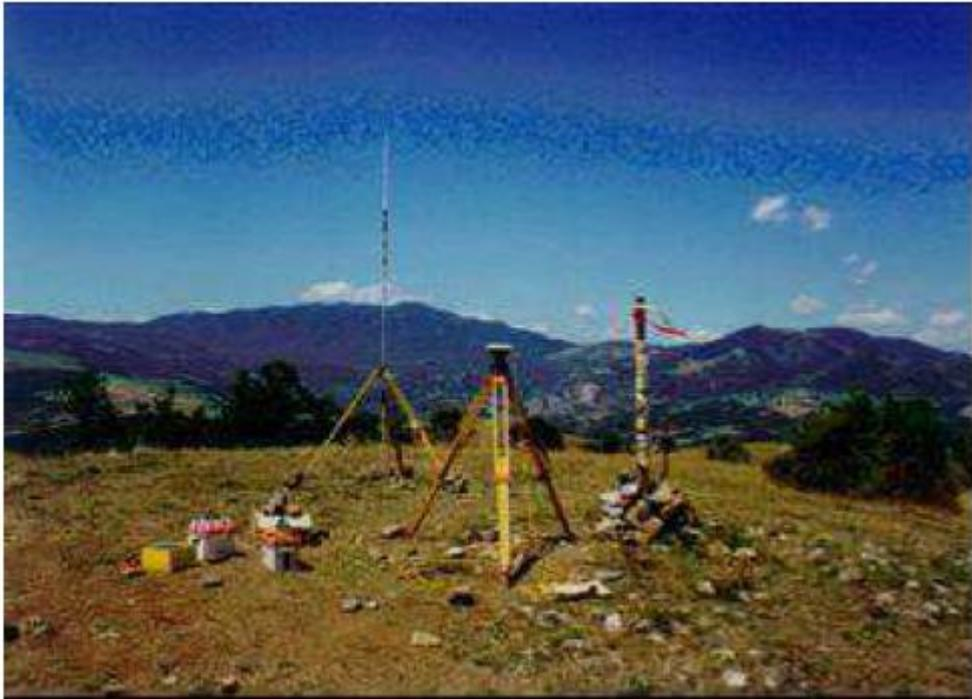
*Figura n. 17: Rilievo topografico mediante uso di GPS*
