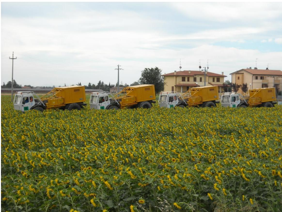
*Figura n. 12: Autocarro Vibroseis*
