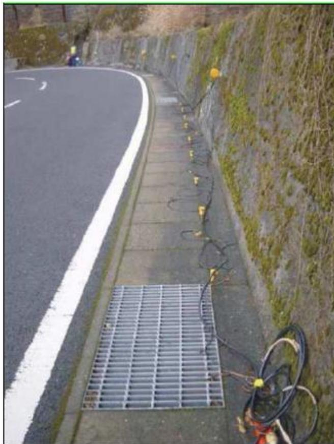
Figura n. 23: Esempio di stendimento geofoni su strada
