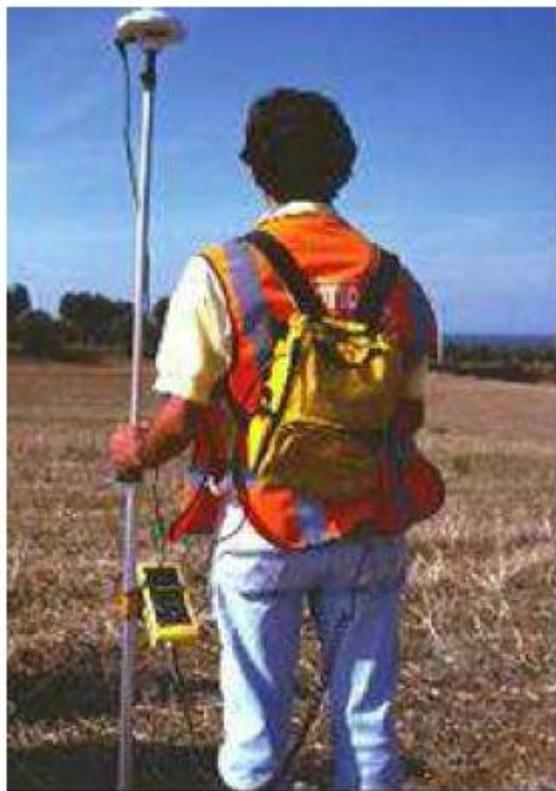
*Figura n. 18: Rilievo topografico mediante uso di GPS*
