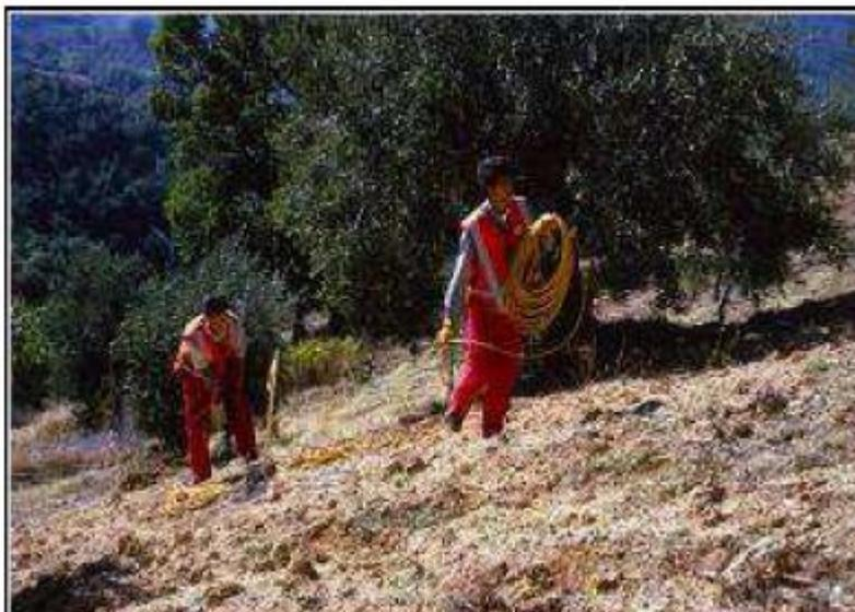
Figura n. 21: Stesura dei cavi, dei geofoni e della strumentazione
