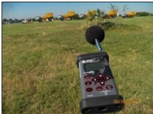
Figura n. 60: Energizzazione con Vibroseis - Misura a 50 m
