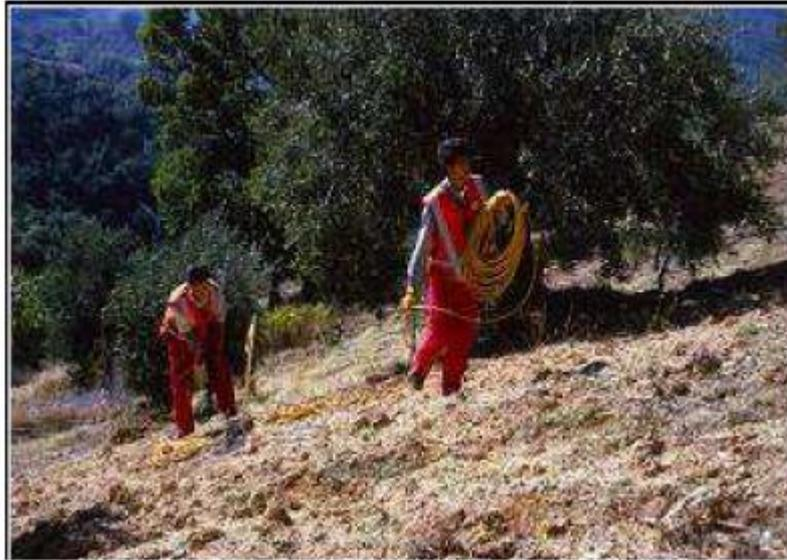
Figura n. 29: Stesura dei cavi, dei geofoni e della strumentazione
