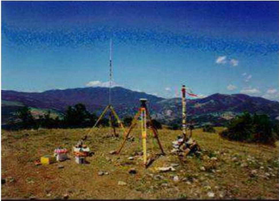
*Figura n. 25: Rilievo topografico mediante uso di GPS*
