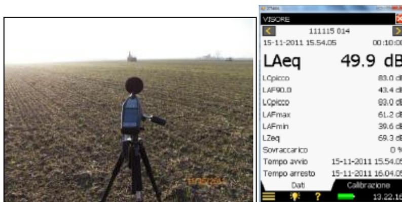
Figura n. 62: Attività di perforazione - Misura a 100 m
