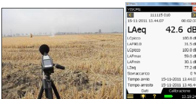
Figura n. 61: Energizzazione con microcarica - Misura a 60m
