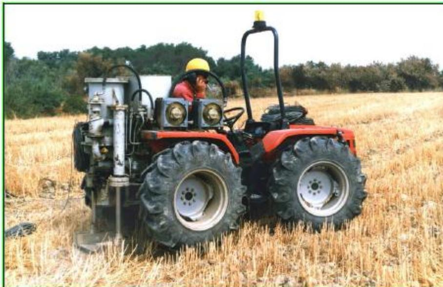
*Figura n. 21: Vibroseis leggero montato su mezzo agricolo operativo in area appenninica*
