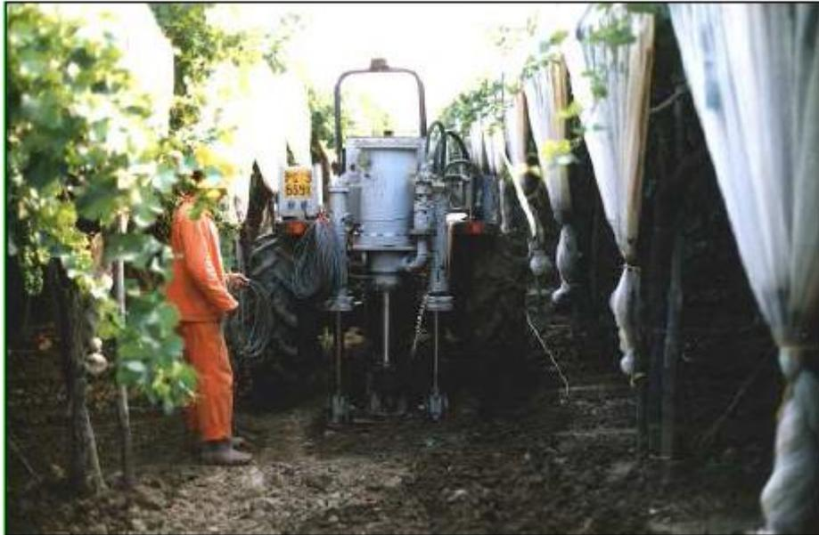
Figura n. 22: Acquisizione mediante sorgente a vibrazione
