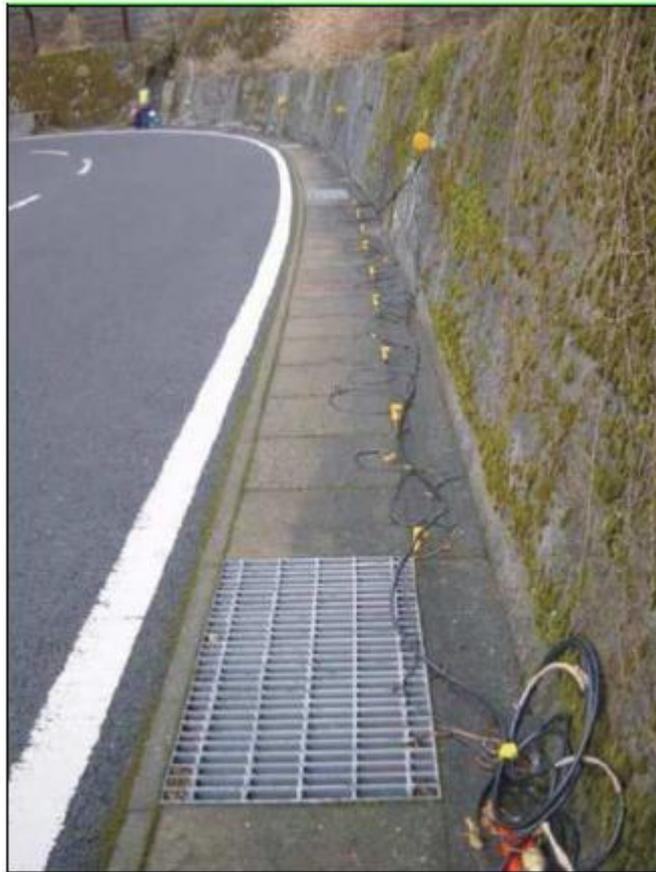
Figura n. 31: Esempio di stendimento geofoni su strada
