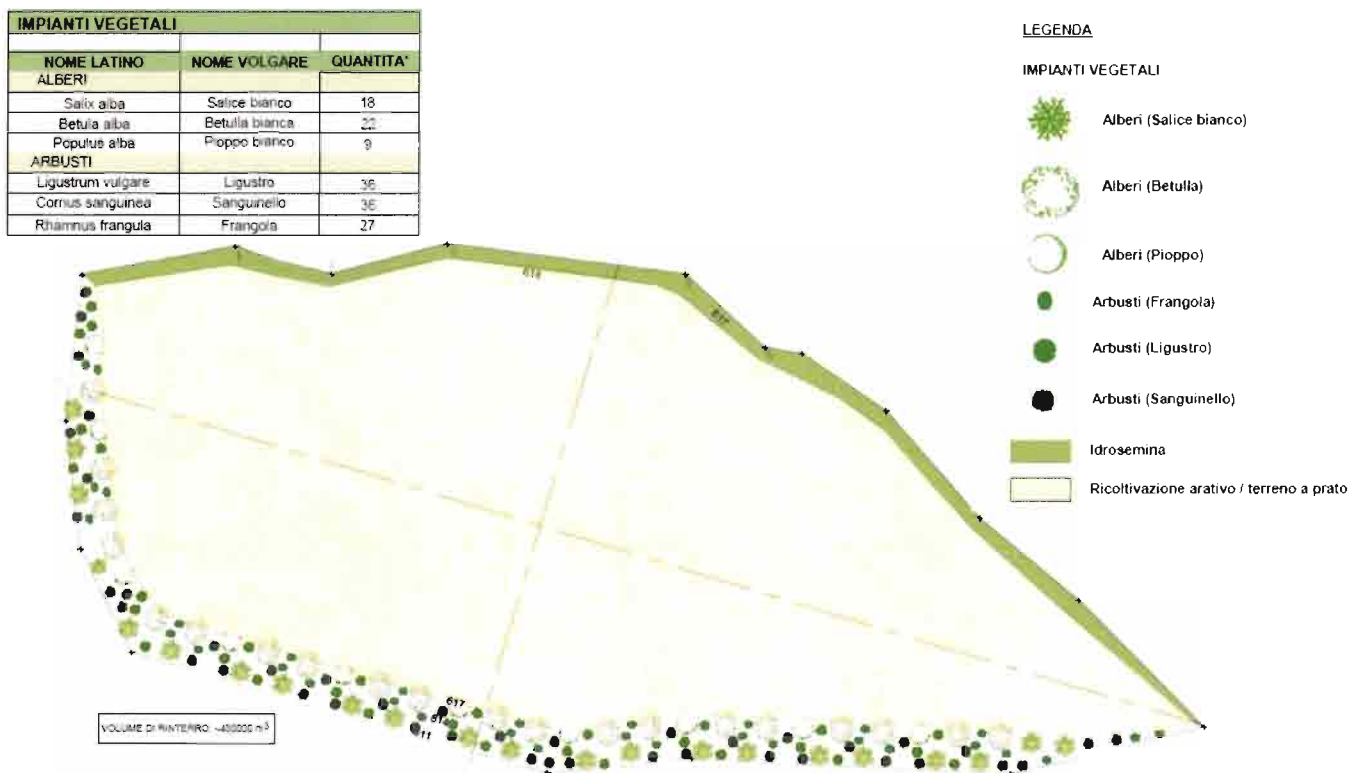
Abbildung 21 - Lageplan der Begrünungsmaßnahmen an der Enddeponie Vorderrigger
