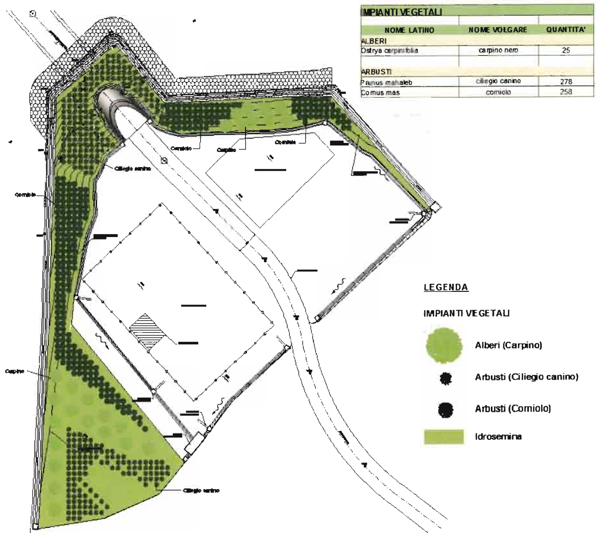
Abbildung 25 - Begrünungsmaßnahmen am Fensterstollen Albeins
