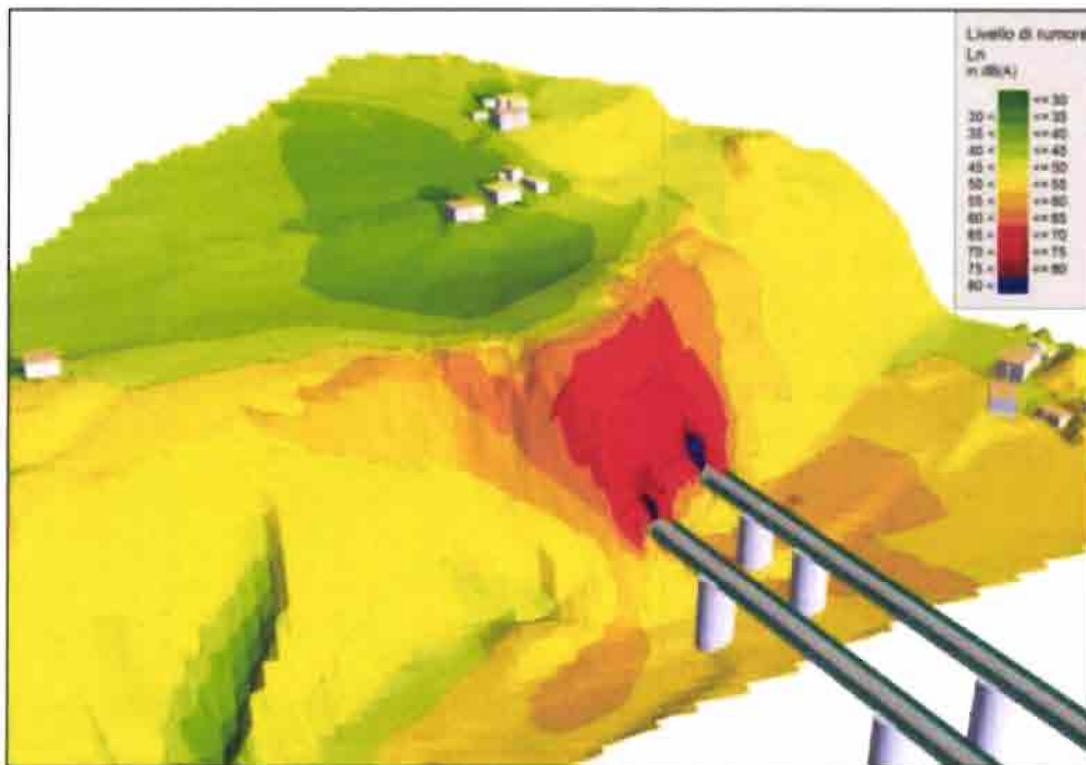
Figura 43 - Mappa acustica 3D (scenario post mitigazione) nella spalla Nord del Ponte sull'Isarco – Periodo notturno
