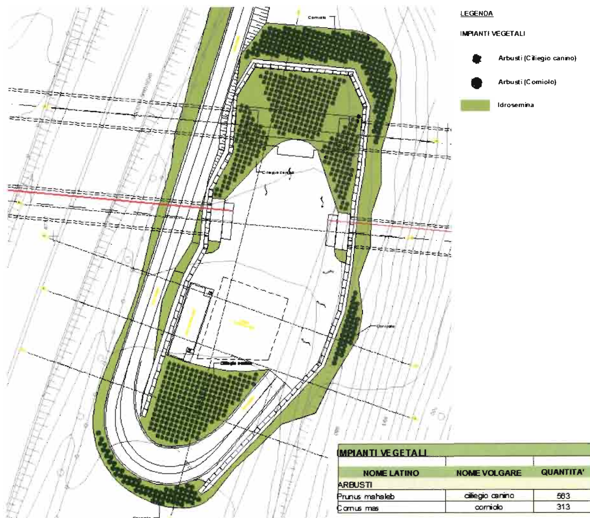
Figura 19 - Opere a verde in corrispondenza della Finestra di Aica
