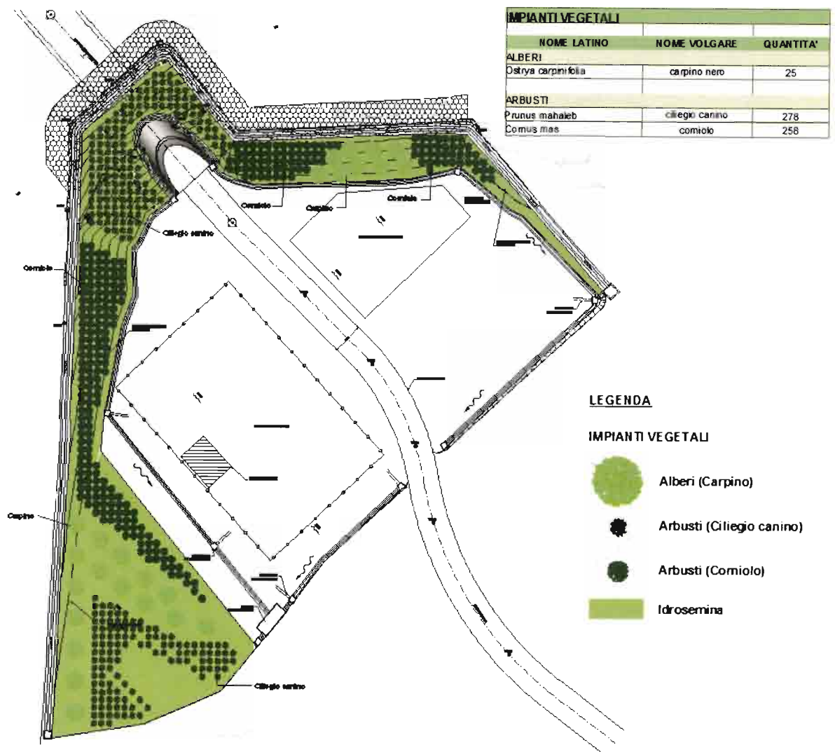
Figura 25 - Opere a verde in corrispondenza della Finestra di Albes
