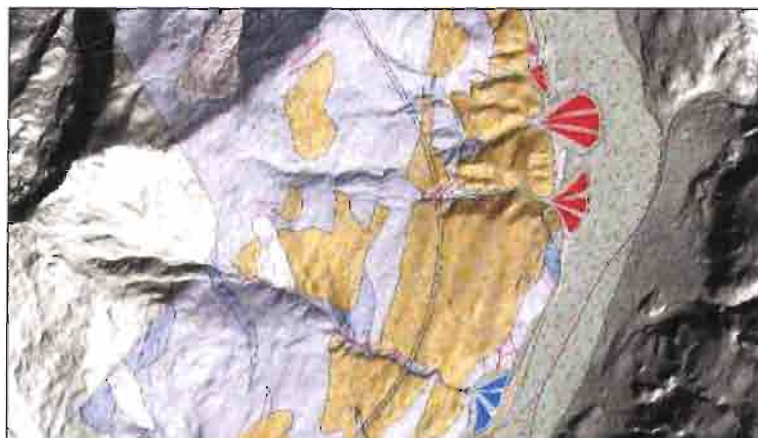
Abbildung 5.4– Streckenabschnitt im Quarzphyllit mit Richtungswechsel der wichtigsten Brüche
