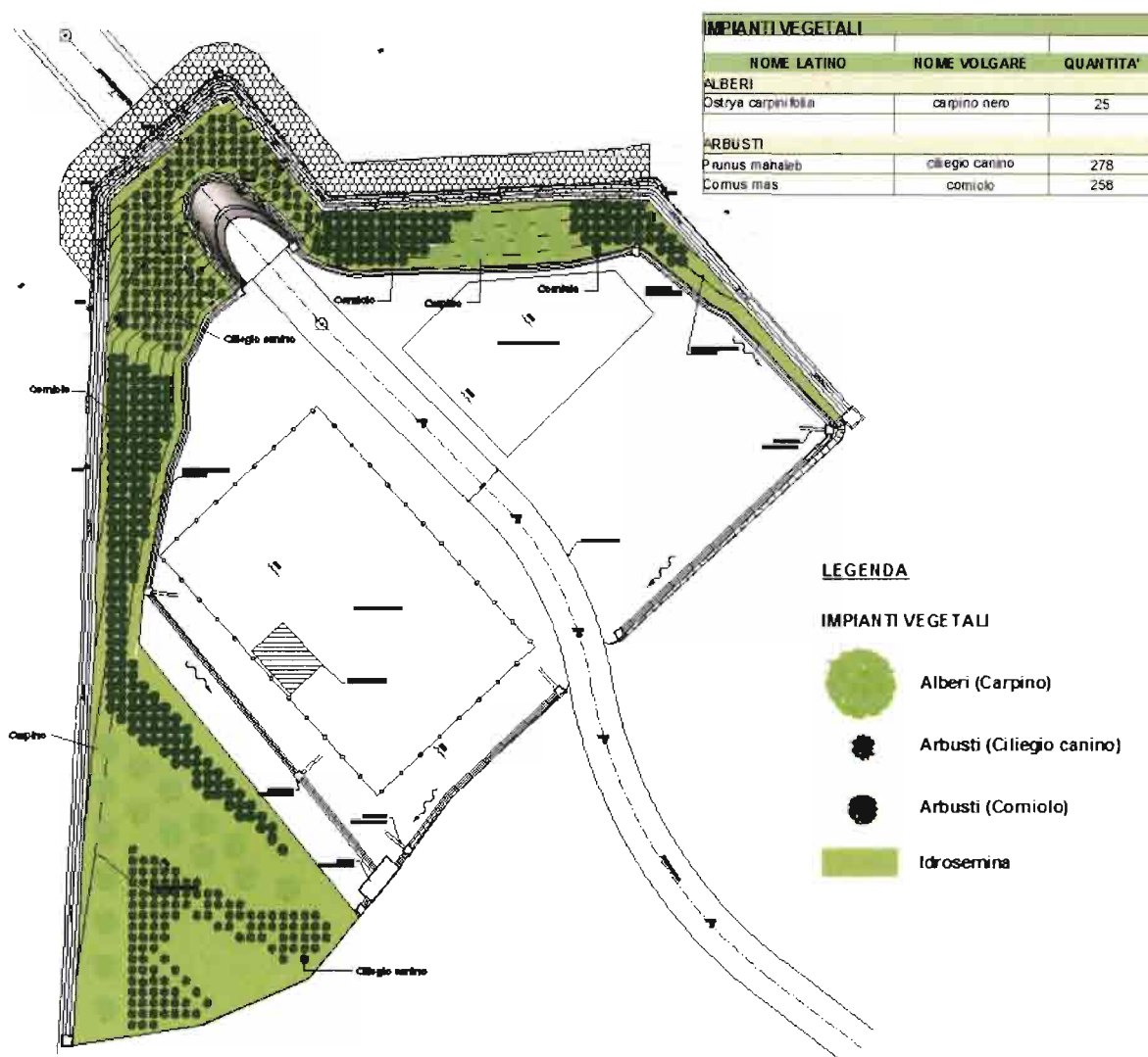
Figura 19.6 - Opere a verde in corrispondenza della Finestra di Albres
