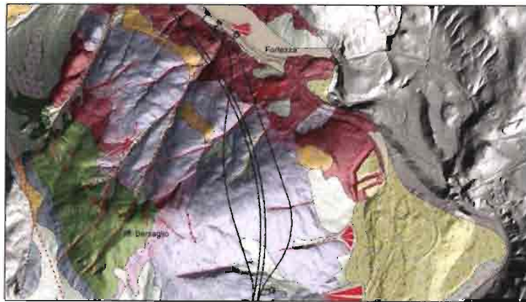
Figura 5.7 - Interconnessioni di Fortezza: si evidenzia il passaggio tra granito (rosso scuro) e filladi (grigio)
