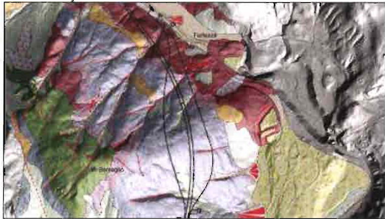
Abbildung 5.7 – Verknüpfung Franzensfeste: hervorgehoben der Übergang zwischen Granit (dunkelrot) und Phyllit (grau)
