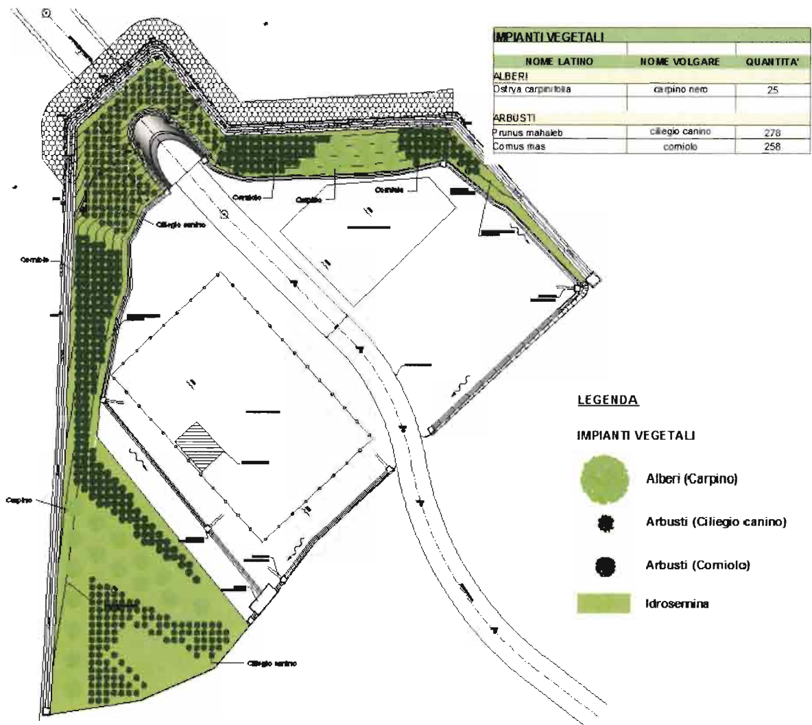
Abbildung 19.6 – Begrünungsmaßnahmen am Fensterstollen Albeins
