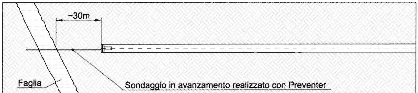
Figura 11.47 - Indagini in avanzamento.
