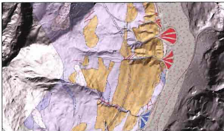
Fig. 11-3 Tratto compreso nelle Filladi Quarzifere con cambio della direzione delle principali fratture.
