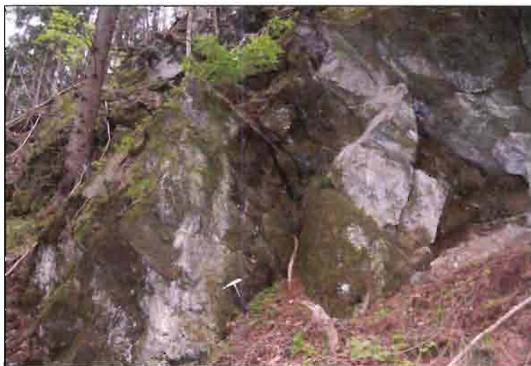
Fig. 15-58 Filladi quarzifere molto ricche in quarzo (Paragneiss), evidente la scistosità e almeno due sistemi di frattura principali.
