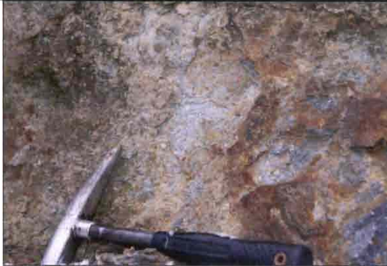
Fig. 15-19 Particolare della breccia di faglia.
