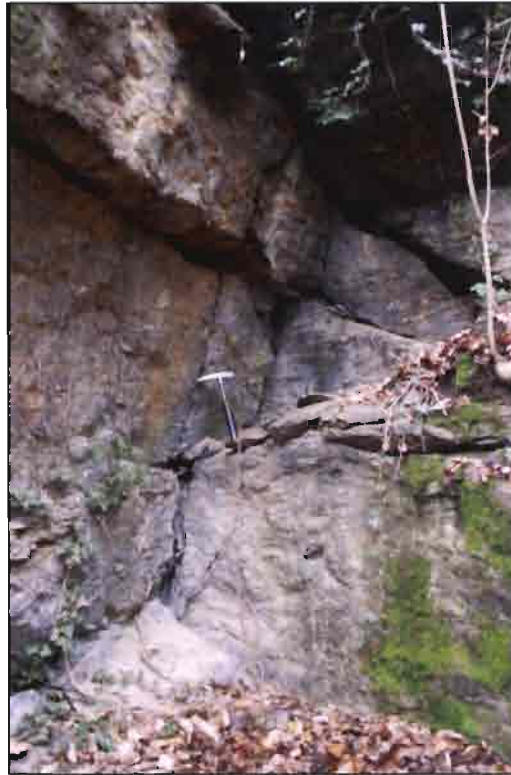
Fig. 15-23 Affioramento con 2 sistemi di frattura e scistosità a basso angolo.
