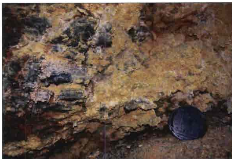
Fig. 15-47 Particolare delle breccie di faglia.
