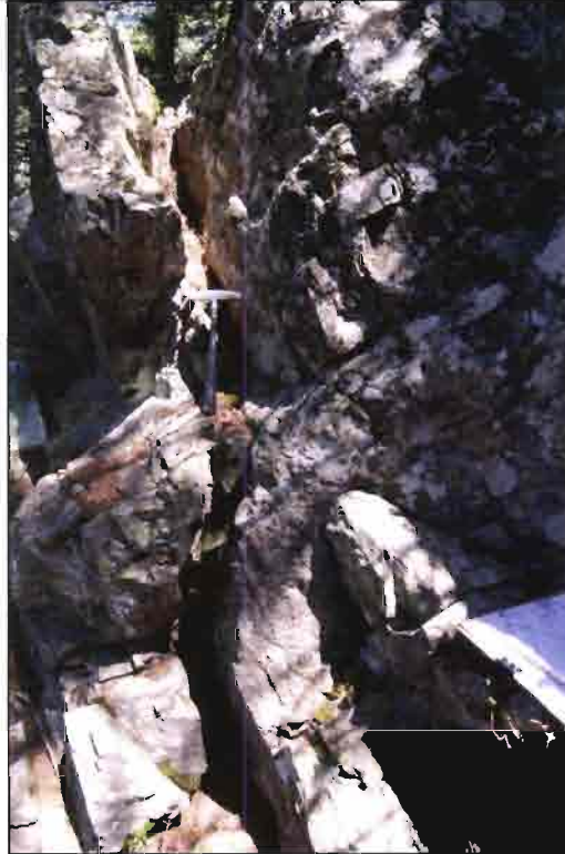
Fig. 15-88. Dioriti del Monte Bersaglio, particolare dell'apertura decimetrica della fratture presenti.
