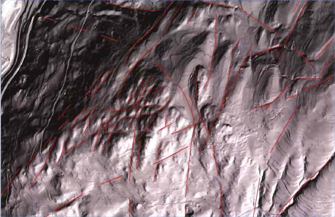
Fig. 9.10 – Particolare del settore centrale caratterizzato dagli elementi legati alla struttura fragile del territorio, con i lineamenti interpretati.
