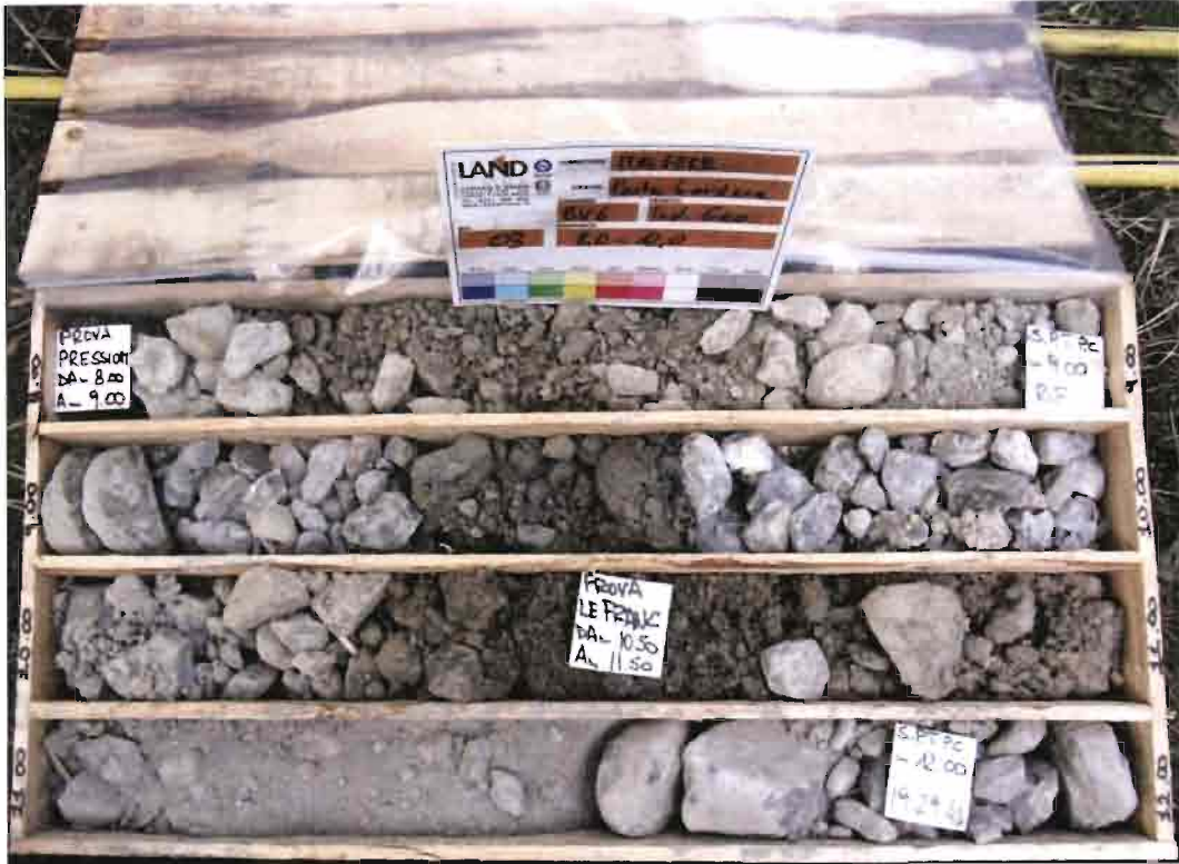
Ponte Gardena (BZ) - BV6 - Box 3 - m 8.00 ÷ m 12.00
