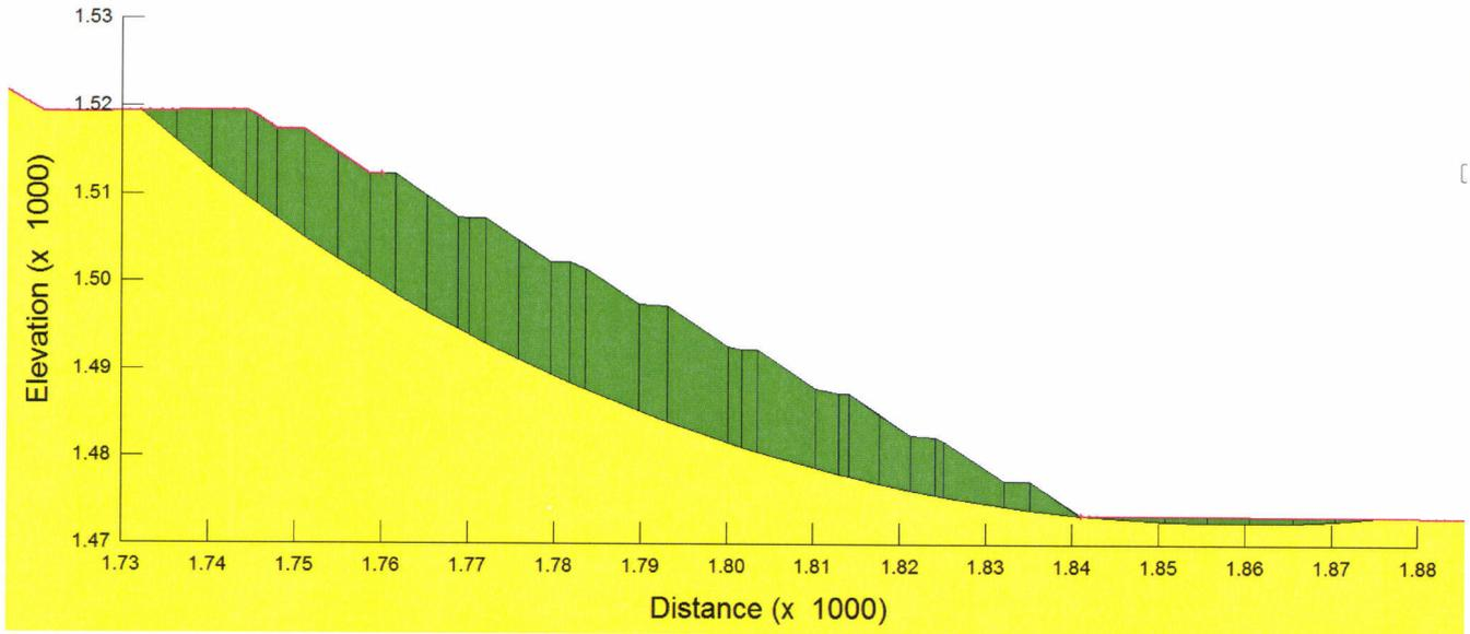
Figura 7: Deposito di Forch (Fase di scavo) – analisi di stabilità globale in campo sismico –  $kv < 0$
