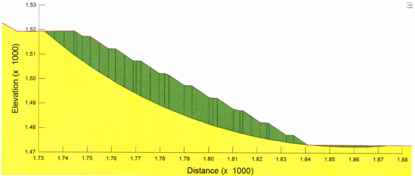
*Figura 5: Deposito di Forch (Fase di scavo) – analisi di stabilità globale in campo statico*
