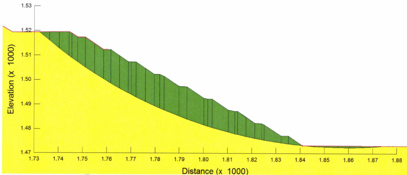
Figura 9: Deposito di Forch (Fase di scavo)– analisi di stabilità globale in campo sismico –  $k_v > 0$
