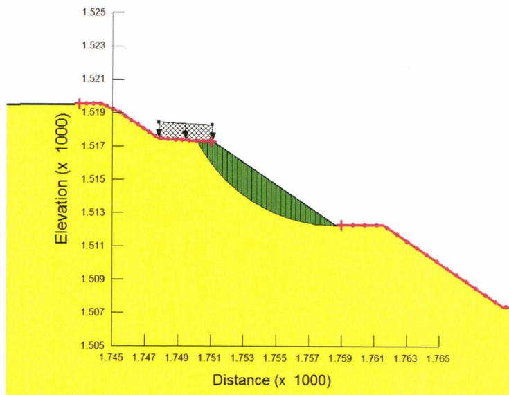
*Figura 6: Deposito di Forch (Fase di scavo) – analisi di stabilità locale in campo statico*
