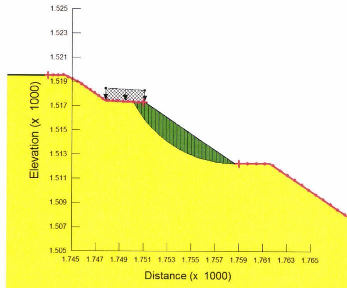
Figura 8: Deposito di Forch (Fase di scavo) – analisi di stabilità locale in campo sismico –  $kv < 0$
