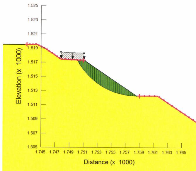
Figura 10: Deposito di Forch (Fase di scavo)– analisi di stabilità locale in campo sismico –  $k_v > 0$
