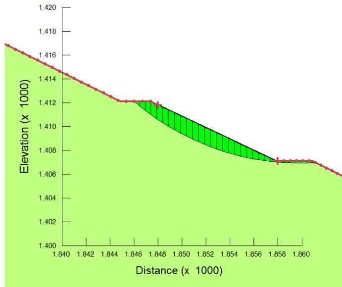
Figura 7: Deposito di Forch (sistemazione finale)– analisi di stabilità locale in campo sismico –  $kv < 0$
