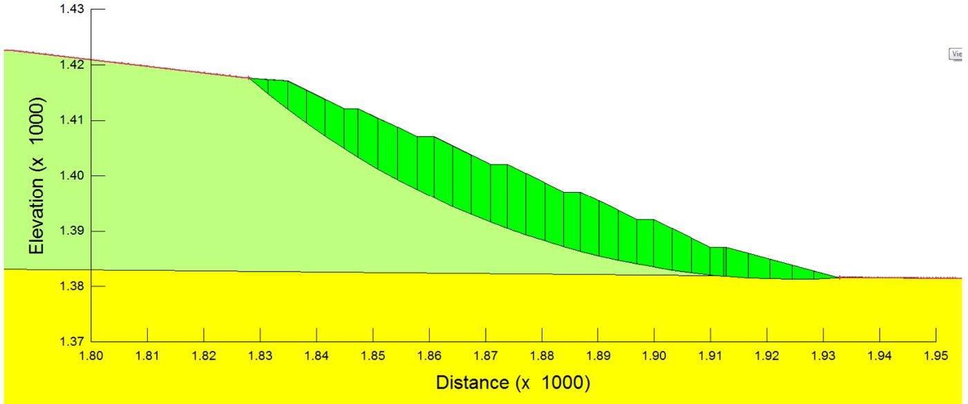
Figura 4: Deposito di Forch (sistemazione finale) – analisi di stabilità globale in campo statico
