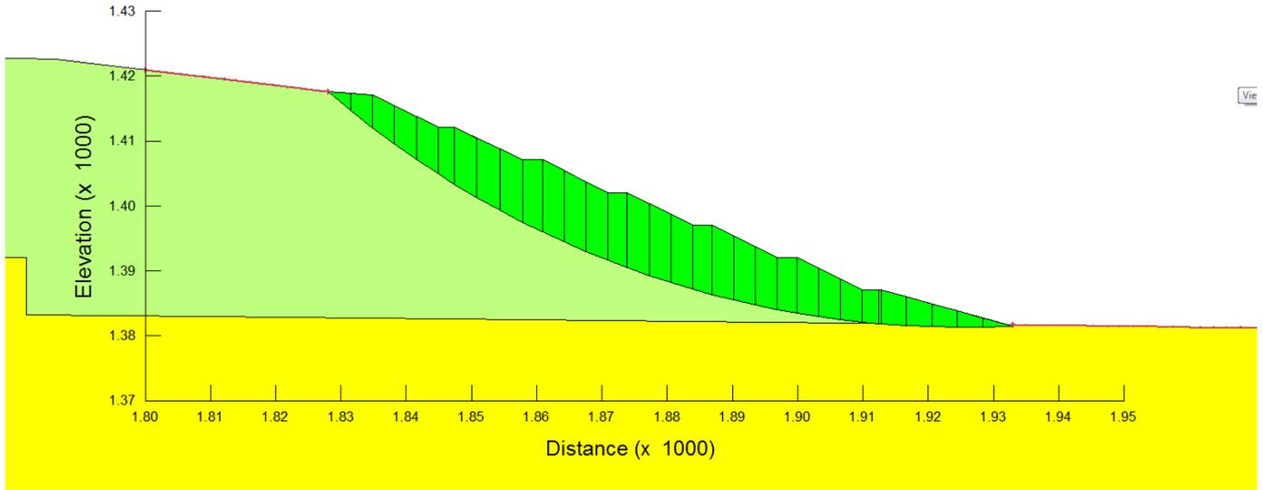
Figura 6: Deposito di Forch (sistemazione finale)– analisi di stabilità globale in campo sismico –  $kv < 0$
