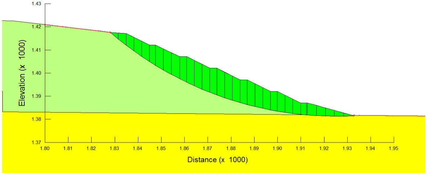
*Figura 8: Deposito di Forch (sistemazione finale)– analisi di stabilità globale in campo sismico –  $k_v > 0$*
