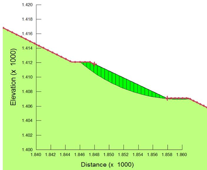
*Figura 9: Deposito di Forch (sistemazione finale)– analisi di stabilità locale in campo sismico –  $k_v > 0$*
