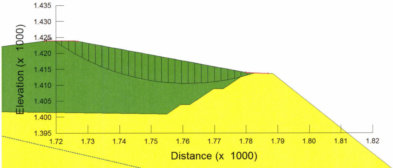
Figura 5: Deposito C (Configurazione di progetto) – analisi di stabilità in campo statico
