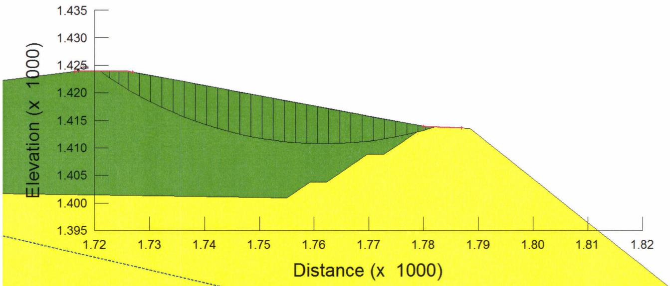
Figura 7: Deposito C (Configurazione di progetto) – analisi di stabilità in campo sismico –  $k_v > 0$
