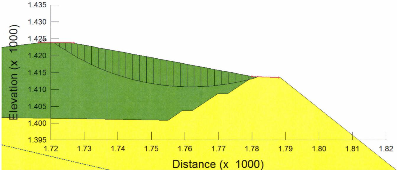
Figura 6: Deposito C (Configurazione di progetto) – analisi di stabilità in campo sismico –  $k_v < 0$
