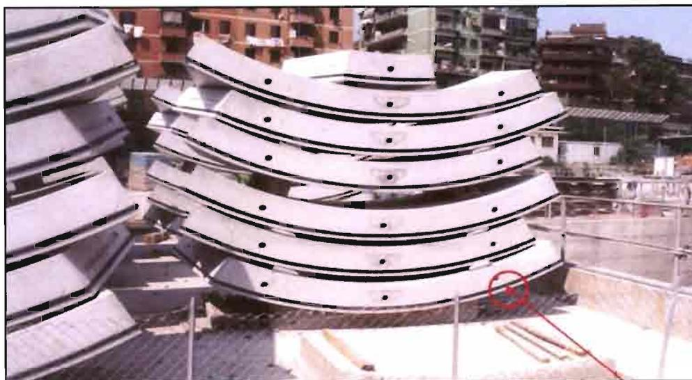
Fig. 12.5 – Conci prefabbricati con guarnizioni in neoprene a tenuta idraulica
