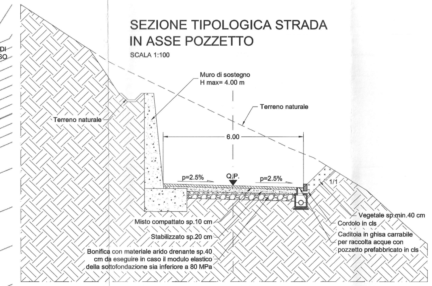
SEZIONE TIPOLOGICA STRADA CORRENTE SCALA 1:100
