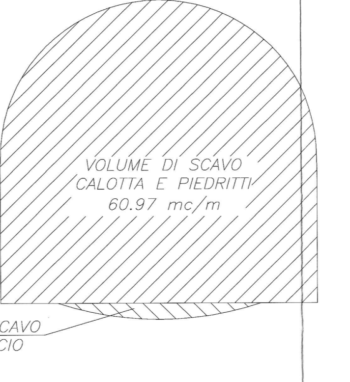
SEZIONE TRASVERSALE DI SCAVO SCALA 1:100
