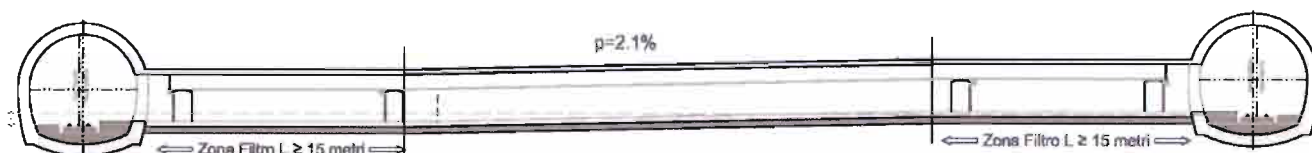
Figura 7 - Profilo longitudinale cunicolo trasversale nelle interconnessioni
