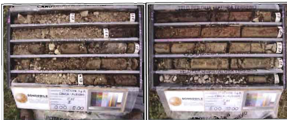
Foto 5-1 Cassetta catalogatrice del sondaggio C11 da 0.00m a 10.00m.
