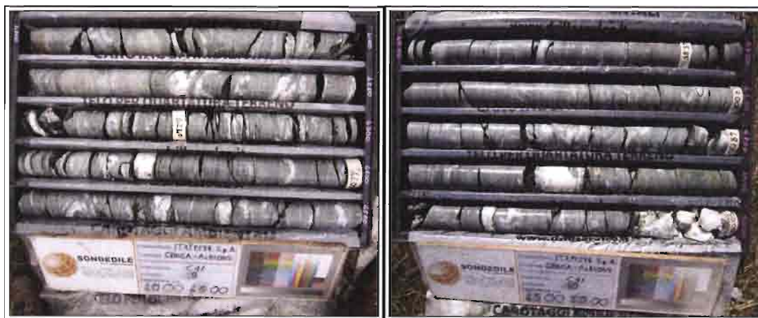
Foto 5-5 Cassetta catalogatrice del sondaggio C11 da 40.00m a 50.00m.
