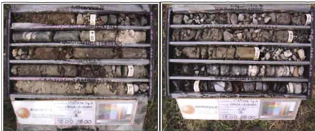
Foto 5-2 Cassetta catalogatrice del sondaggio C11 da 10.00m a 20.00m.
