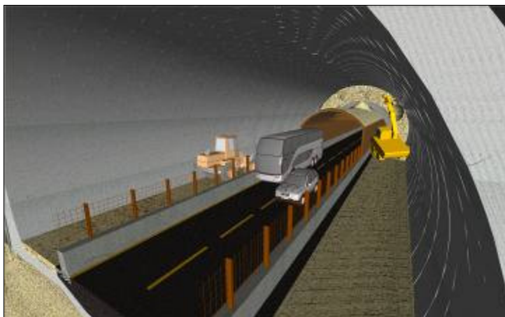
Fig. 6.2: Barriere di protezione e sagoma limite carreggiata
