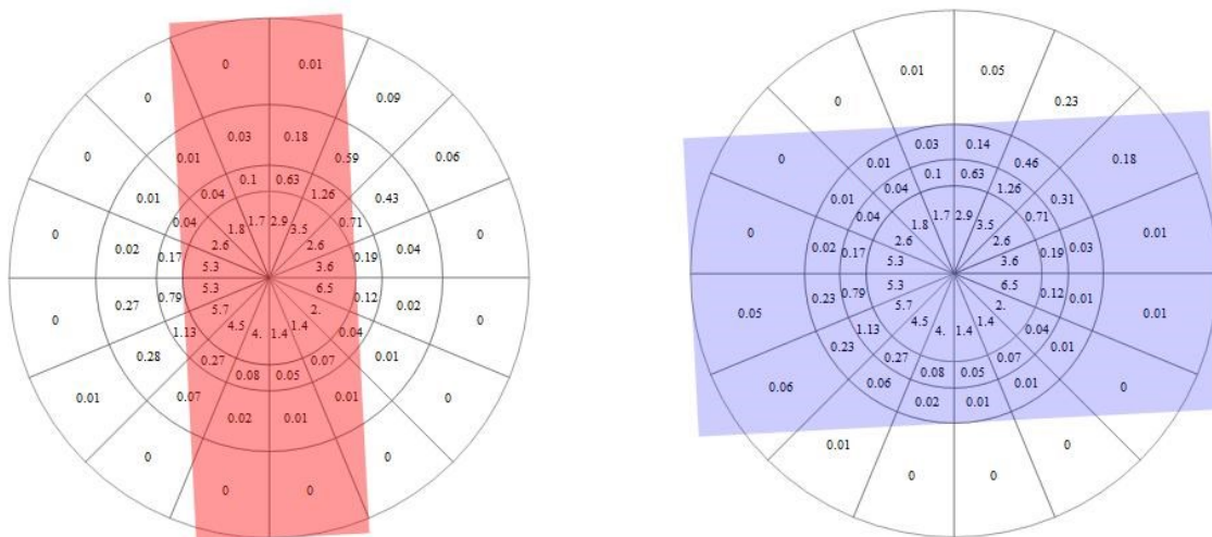
Figura 3.7. Rose dei venti per l’ipotesi di pista con orientazione 09-27 considerata nell’PIT della Regione Toscana, per il periodo 2005-2014, orario 6-24. A destra: rosa dei venti modificata per il calcolo dei dirottamenti dovuti al vento in coda. A sinistra: rosa dei venti per il calcolo del CU secondo la metodologia FAA per i limiti di vento al traverso. L’incidenza dei venti limitanti è 0.5%.
