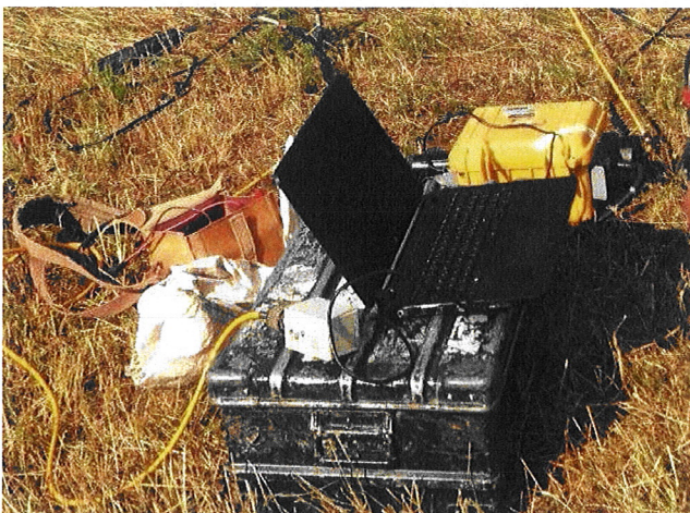
Fig 5.2 Strumentazione sismica a rifrazione
