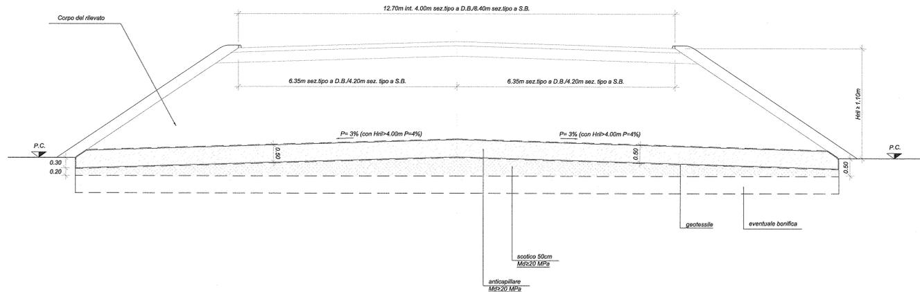
Sezione tipo in rilevato -  $0,90m \leq H_{rij} < 1,10$  m
