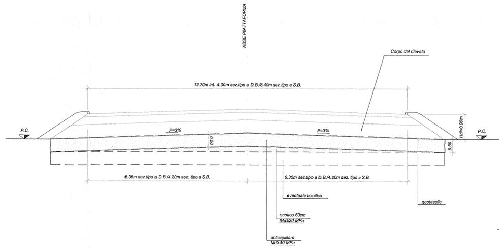
Sezione tipo in rilevato -  $H_{rij} \geq 1,10$  m
