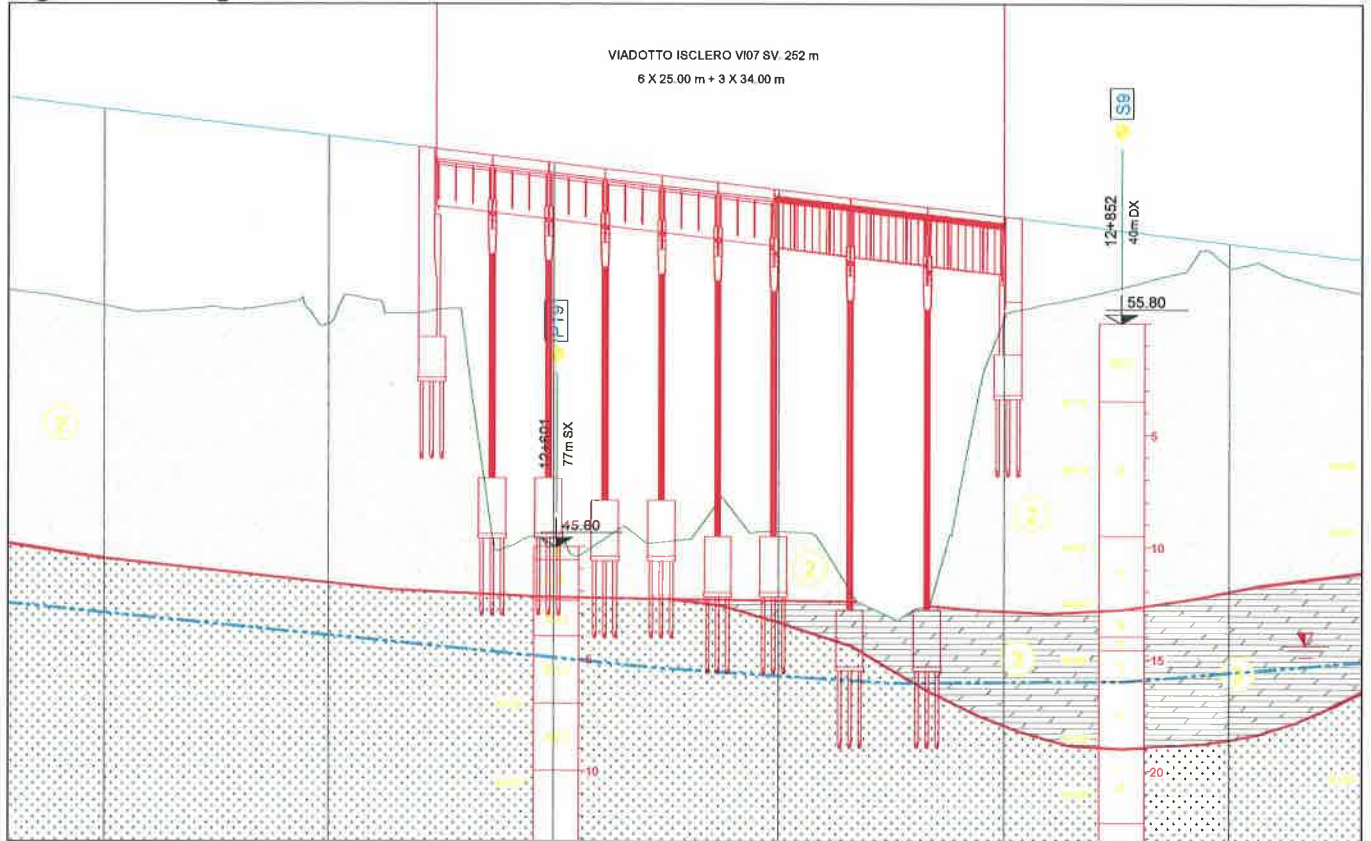
Fig. 4.9-Profilo geotecnico Fiume Isclero
