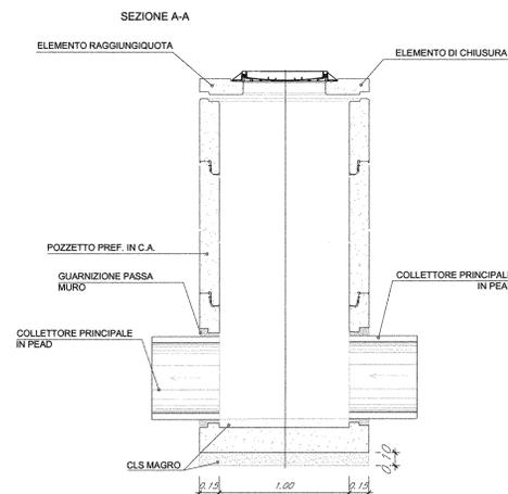
PARTICOLARE POZZETTO D'ISPEZIONE
