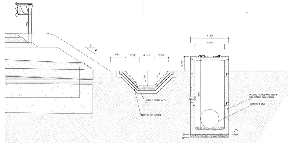
POZZETTI D'ISPEZIONE COLLETTORE PER ACQUE BIANCHE CON FUNZIONAMENTO A GRAVITA'
