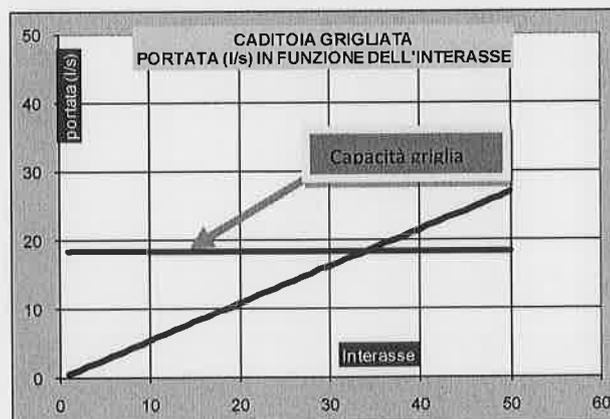
*Figura 1.6-4: Caditoia grigliata confronto fra la capacità idraulica e la portata di pioggia in funzione dell'interasse*
