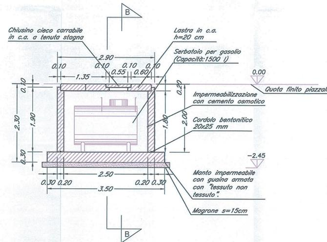
**SOLAIO SEZIONE A-A**
