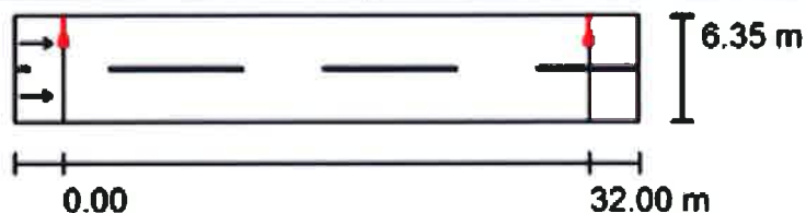
Figura 7 - Disposizione apparecchi illuminanti
