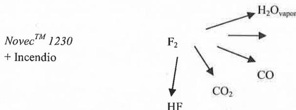
Figura 2: Decomposizione termica del Fluido Novec<sup>TM</sup> 1230 nella zona della reazione
