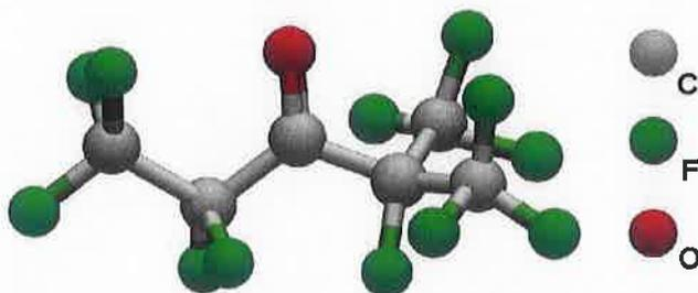
Figura 1: Struttura Chimica del Fluido Novec™ 1230
