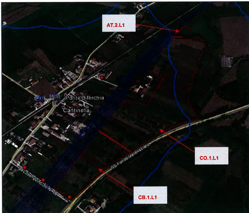
Figura 5-6 - Localizzazione delle aree di cantiere (evidenziate in rosso), rispetto al vincolo della fascia di rispetto del torrente Isclero evidenziata in blu)
