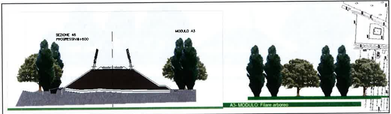
Figura 6-9 - Interventi di mitigazione in corrispondenza del rilevato a sud di Maddaloni
