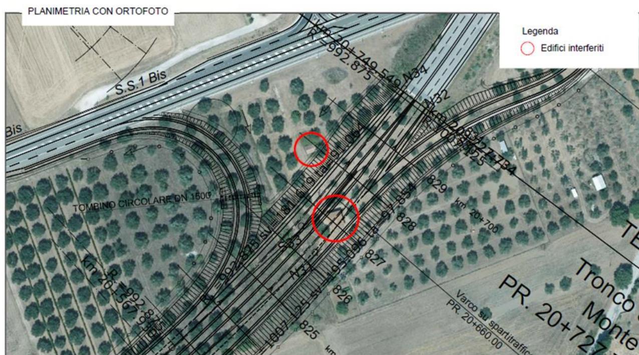
Figura 4.19-1: Localizzazione dei due manufatti interferiti nei pressi dello svincolo Cinelli
