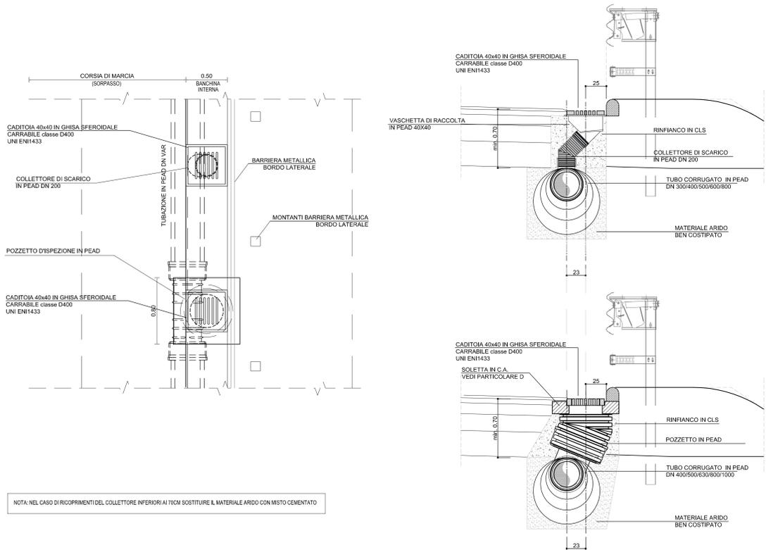
NOTA: NEL CASO DI RICOPRIMENTI DEL COLLETTORE INFERIORI AI 70CM SOSTITUIRE IL MATERIALE ARIDO CON MISTO CEMENTATO
