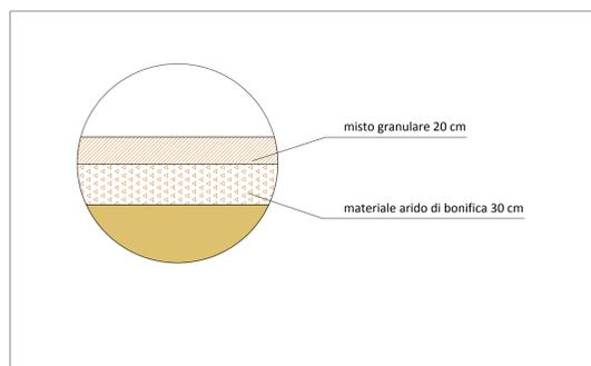
PARTICOLARE PAVIMENTAZIONE DI PROGETTO
