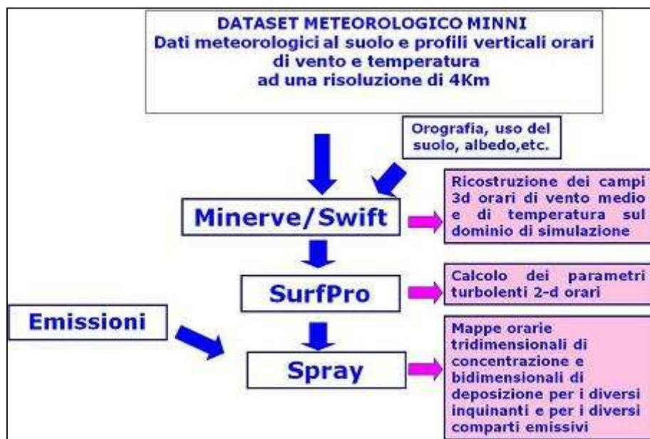
Figura 7.25: Schema del sistema modellistico utilizzato
