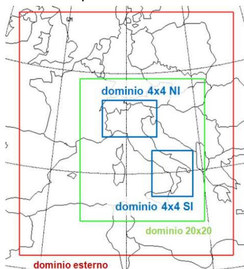
**Figura 7.10: sistema di griglie innestate utilizzate in MINNI.**
