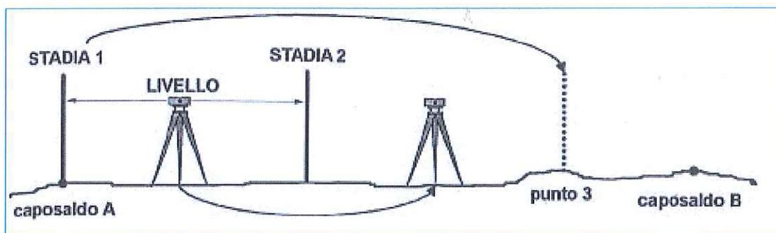
Figura 2: rappresentazione schematica livellazione
