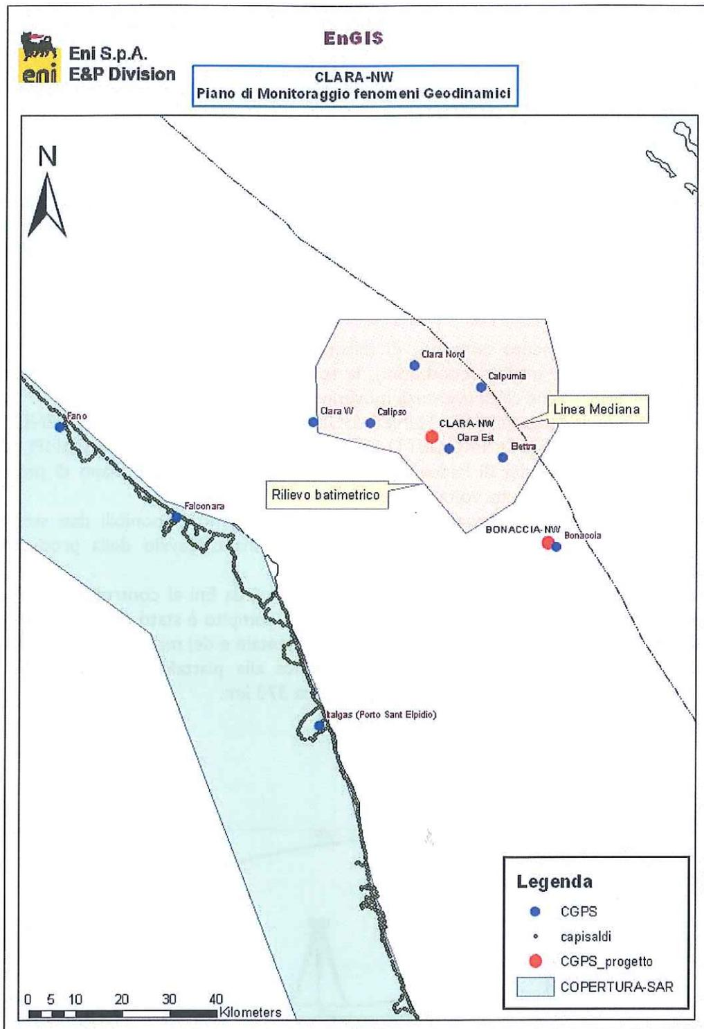
Figura I: rete di monitoraggio della subsidenza proposta-progetto Clara NW
