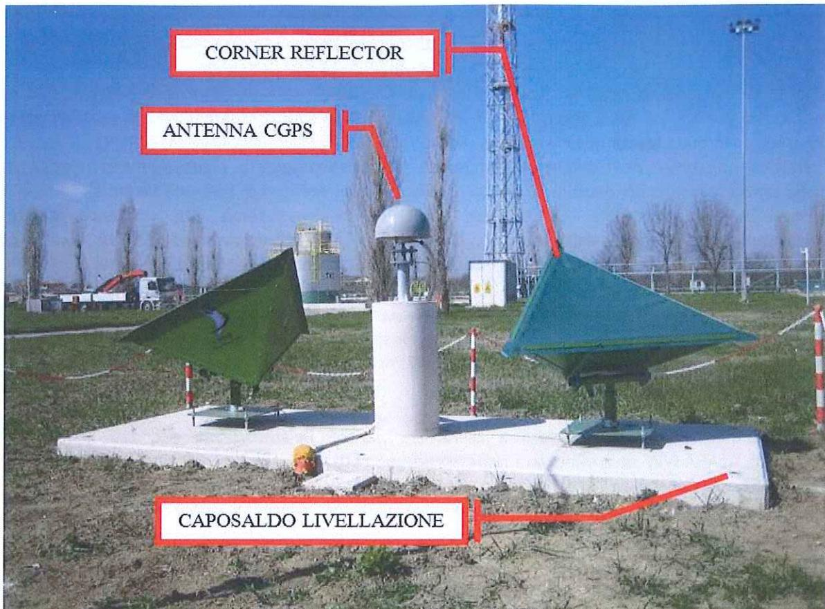
Figura 3: una stazione tipo nella configurazione S.S.U.
