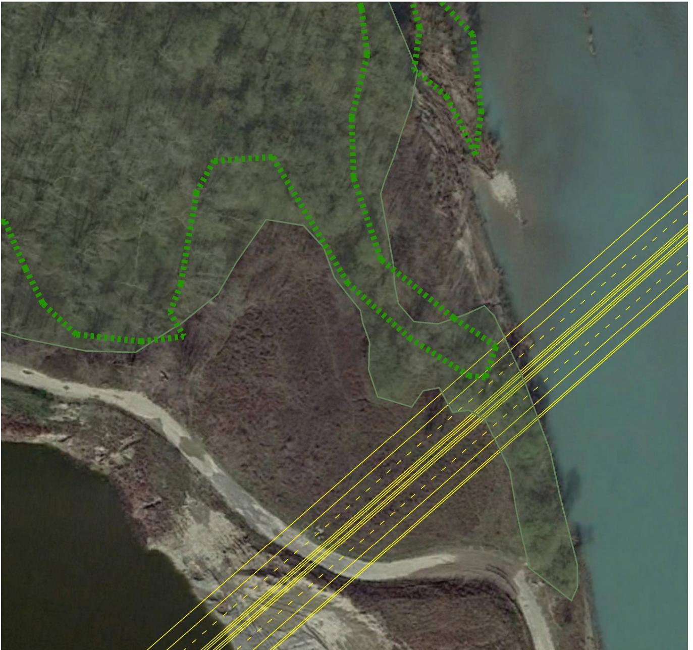
Figura 8.2 - Sovrapposizione su ortofoto con individuazione in verde delle zone effettivamente boscate, del perimetro, con una linea verde tratteggiata, delle zone boscate da P.T.C.P., e del tracciato autostradale da Progetto Definitivo .
