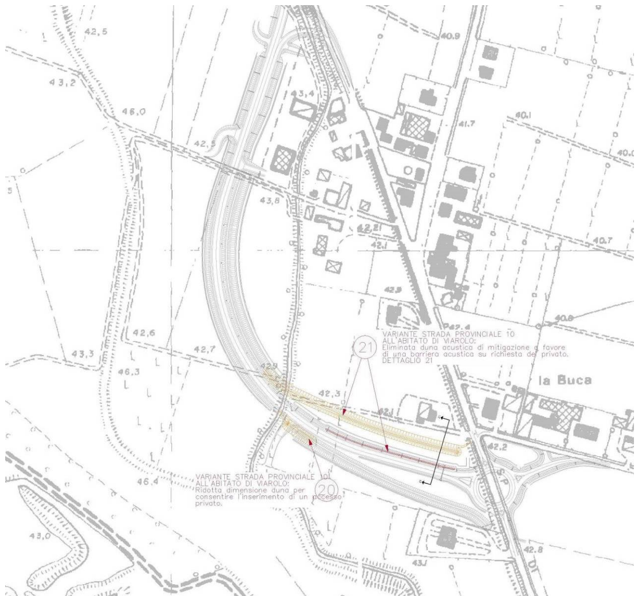
Figura 6.11 – Planimetria con individuazione delle varianti 20 e 21, in arancione le porzioni stralciate dal Progetto Esecutivo, in rosso i nuovi elementi di progetto ed in nero la traccia della sezione 21 di raffronto tra le previsioni di PD e PE.
