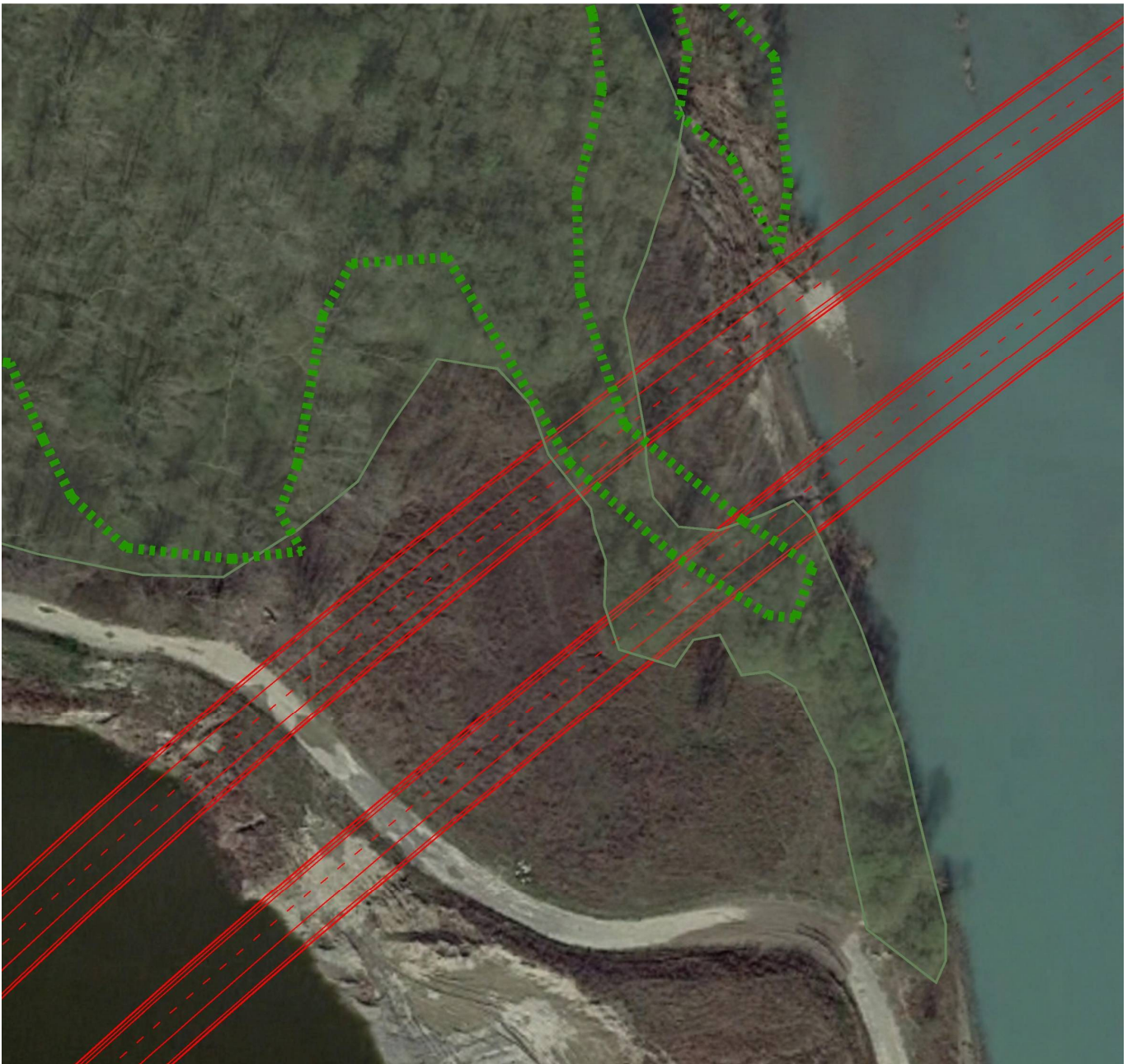
Figura 8.3 - Sovrapposizione su ortofoto con individuazione in verde delle zone effettivamente boscate, del perimetro, con una linea verde tratteggiata, delle zone boscate da P.T.C.P., e del tracciato autostradale da Progetto Esecutivo .
