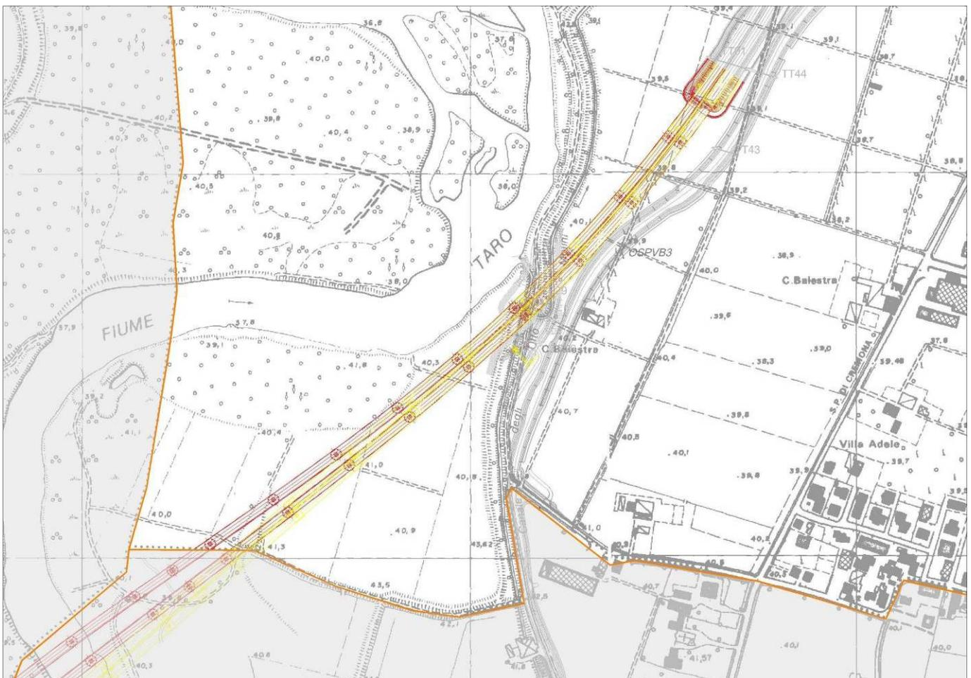
Figura 6.1 - Planimetria con evidenziazione della variante del tracciato del ponte sul Fiume Taro. In giallo il tracciato da Progetto Definitivo, in rosso il tracciato da Progetto Esecutivo.
