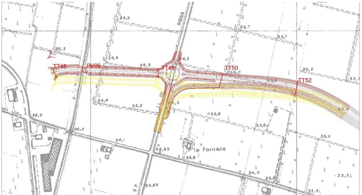
Figura 6.14 – Planimetria con individuazione della variazione al tracciato stradale del raccordo Autostazione Trecasali - Terre Verdiane rotatoria S.P. 10. In giallo il tracciato da **Progetto Definitivo**, in rosso il tracciato da **Progetto Esecutivo**.
