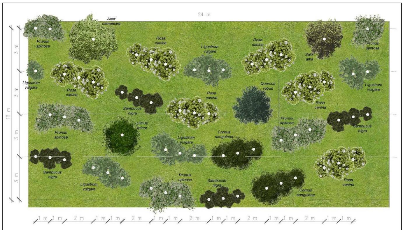
Figura 7.3 - Schema di impianto della tipologia ad arbusteto evoluto.
