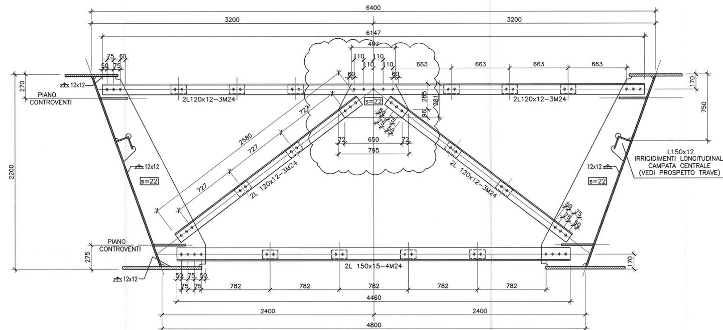
DETTAGLIO IRRIGIDIMENTO LONGITUDINALE
