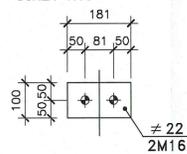
DETTAGLIO GIUNTO IRRIGIDIMENTO VERTICALE
