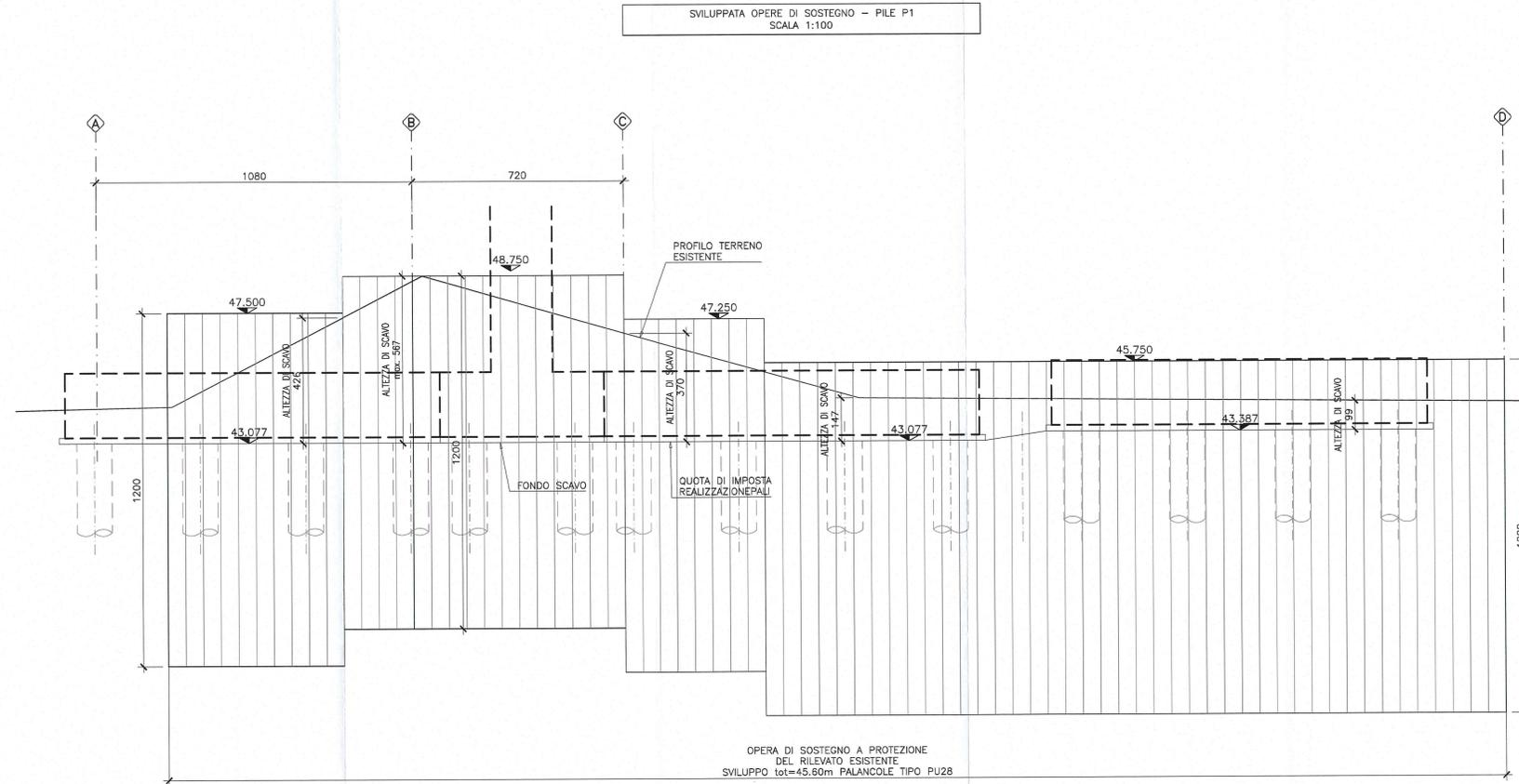
OPERA DI SOSTEGNO A PROTEZIONE DEL RILEVATO ESISTENTE SVILUPPO tot=45,60m PALANCOLE TIPO PU28
