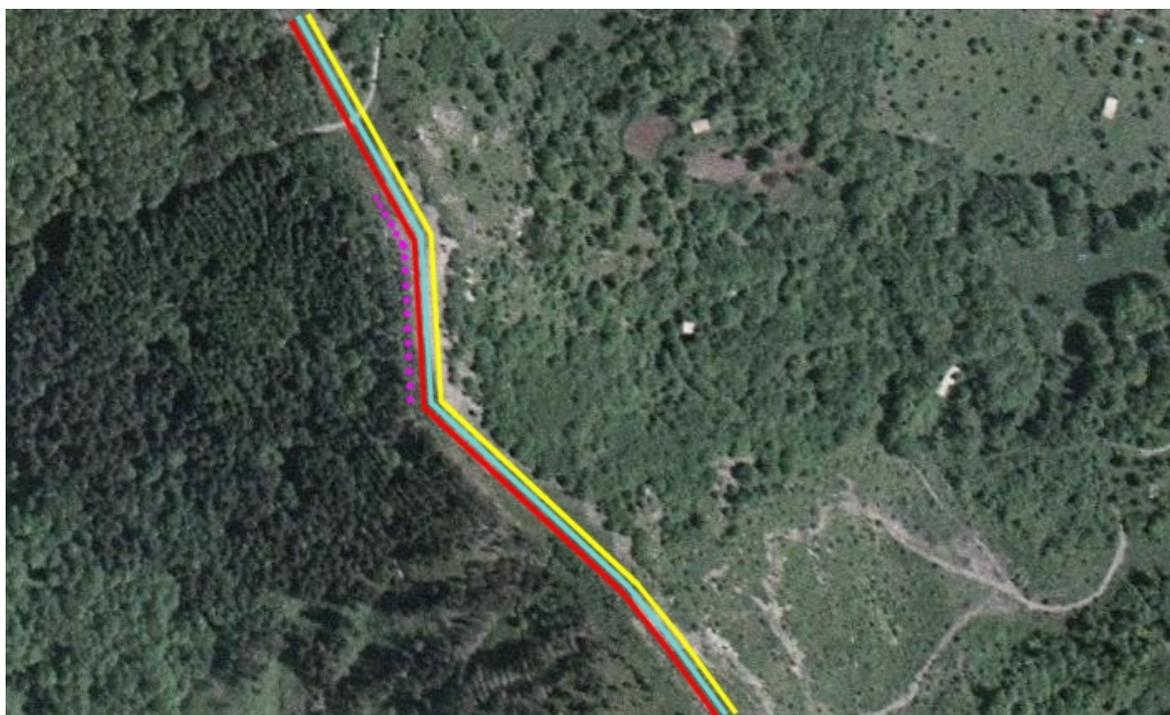
**Fig. 4.3/N:** Particolare dell'immagine precedente (in giallo il Ga.Me.A, in azzurro il Ga.Me.B ed in rosso il Ga.Me.C, in viola il tratto in cui sono state realizzate le opere di contenimento e sostegno)
