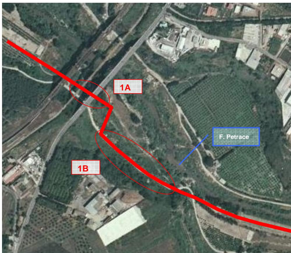
**Fig. 4.3/A: Attraversamento linea ferroviaria "Cosenza Reggio C.", SS n 18 e percorrenza via Tauriana (in rosso corridoio Ga,Me.B, C**
