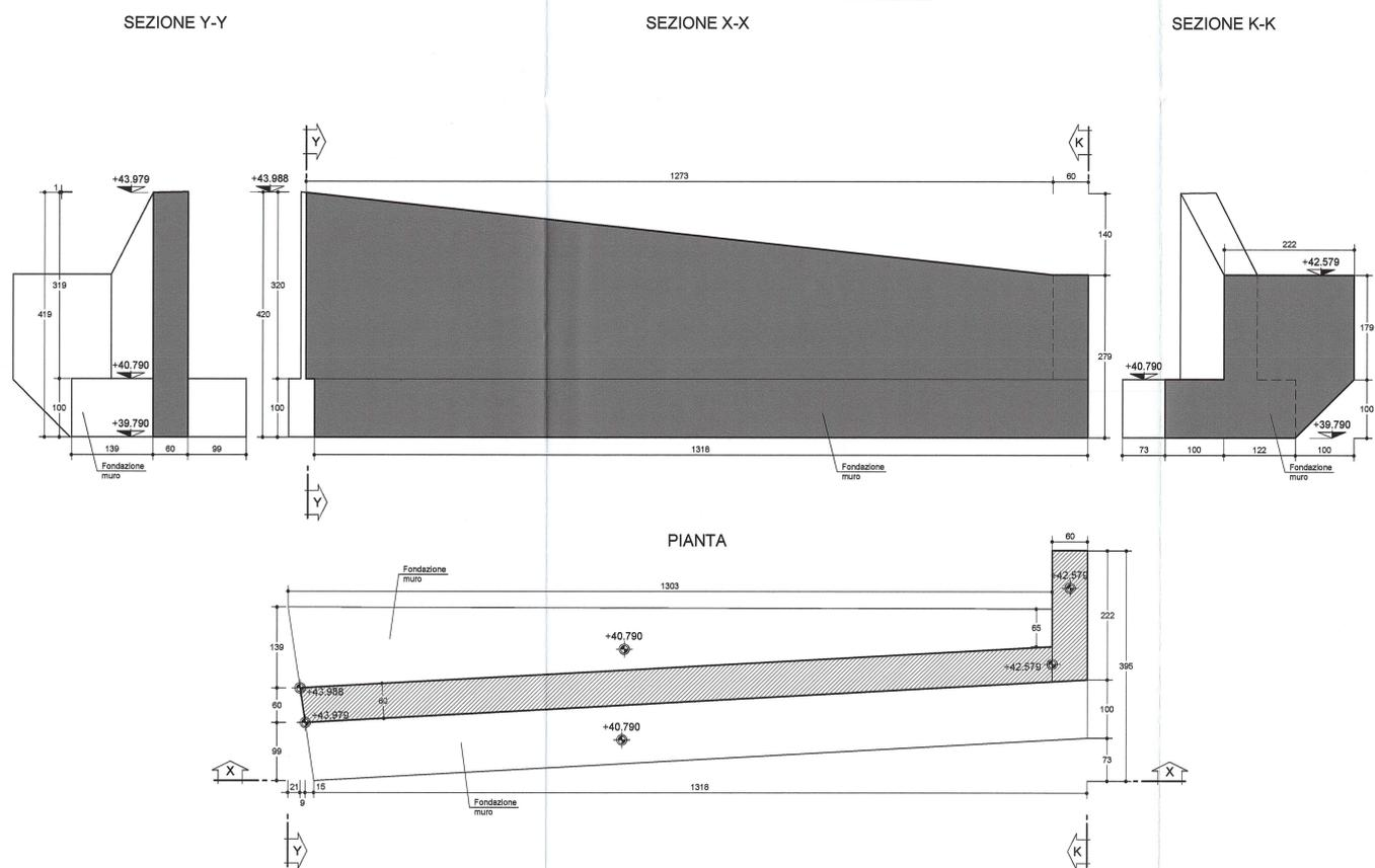
MURO DI PROTEZIONE SPARTITRAFFICO
