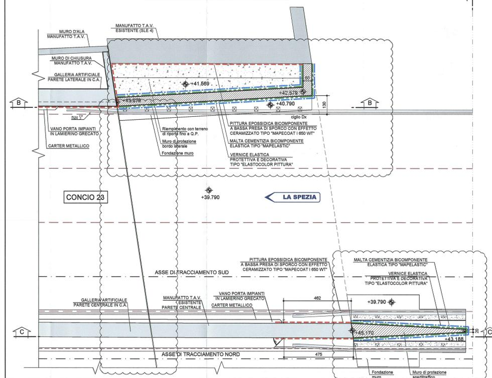
MURO DI PROTEZIONE BORDO LATERALE
