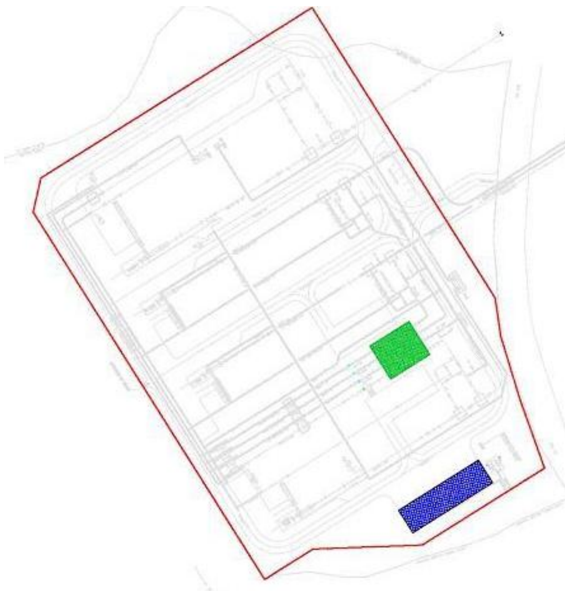
Fig. 2.1/A: Principali sorgenti di rumore del nuovo terminale ( in verde, valvole di regolazione; in blu, sistema produzione aria compressa)
