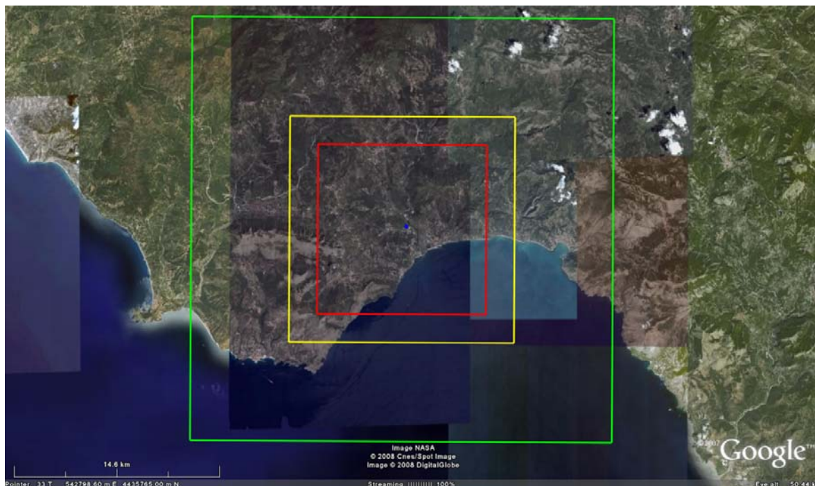
Fig. 6.1/A: Domini di simulazione di CALMET (verde), CALPUFF computazionale (giallo) e CALPUFF campionamento (rosso).
