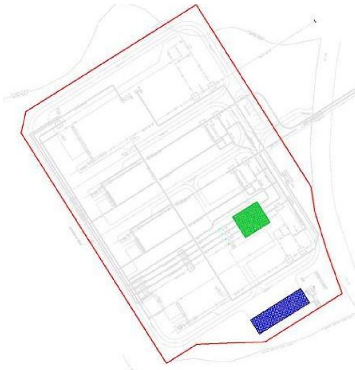
Fig. 3.2/B: Aree di emissione di rumore nell'ambito dell'impianto dei terminali di Policastro Bussentino ( in verde, valvole di regolazione; in blu, sistema produzione aria compressa)
