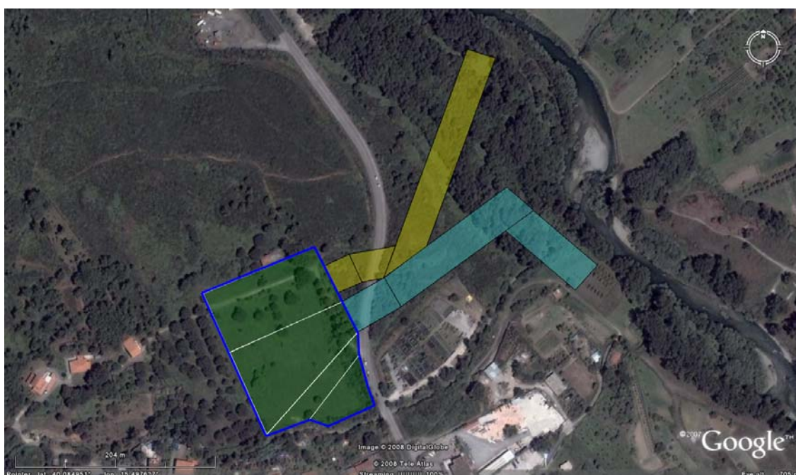
Figura 6.2: Sorgenti areali rappresentate in CALPUFF: terminale (poligono blu suddiviso in 4 quadrilateri verdi), area di passaggio DN 800 (32")-(tre quadrilateri azzurri) e DN 1200 (48")-(tre quadrilateri gialli).
