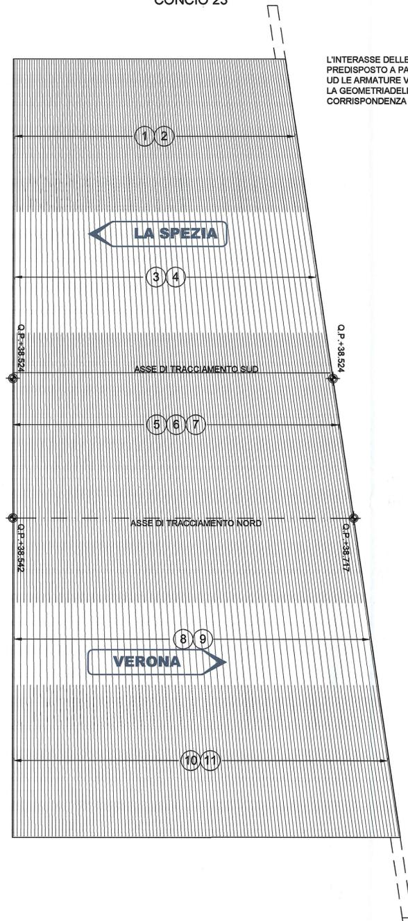
L'INTERASSE DELLE BARRE, COSI' COME INDICATO IN SEZIONE, VERRA' PREDISPOSTO A PARTIRE DAL PIEDRITTO LATERALE DELLA CANNA. LE ARMATURE VERRANNO POSIZIONATE IN MODO TALE DA SEGUIRE LA GEOMETRIA DELLA SOLETTA, AUMENTANDO L'INTERASSE IN CORRISPONDENZA DELLA CANNA NORD.
