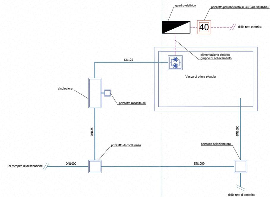
Schema di funzionamento dell'impianto trattamento acque
