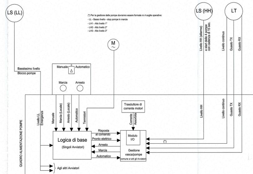
Schema unifilare tipo dell'impianto di sollevamento
